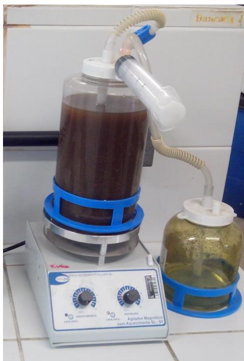
Figura 61 – Sistema de fermentação com agitação magnética
