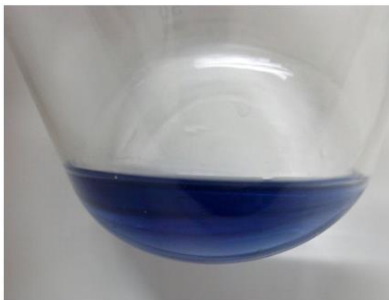
Figura 41 – Teste do iodo realizado em uma extração com água contendo amido
