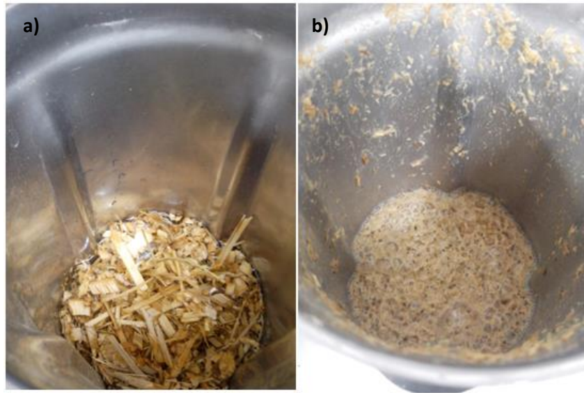
Figura 31 – Bambu em cavaco: a) antes e b) depois do desfibramento
