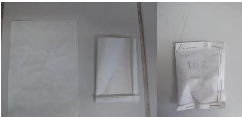
Figura 34 – Montagem do cartucho para a remoção de extrativos
