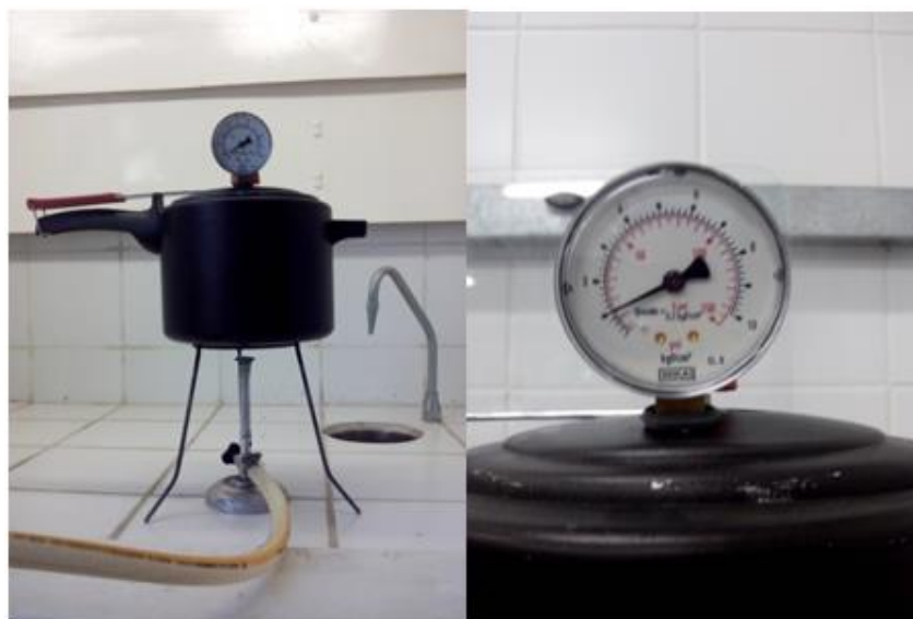
Figura 32 – Reator confeccionado para os experimentos com manômetro em destaque
