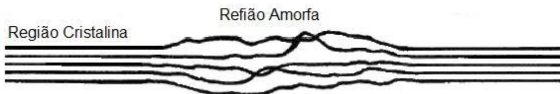
Figura 7 – Representação esquemática da organização das cadeias de celulose Fonte: adaptada de Gurgel, 2010
