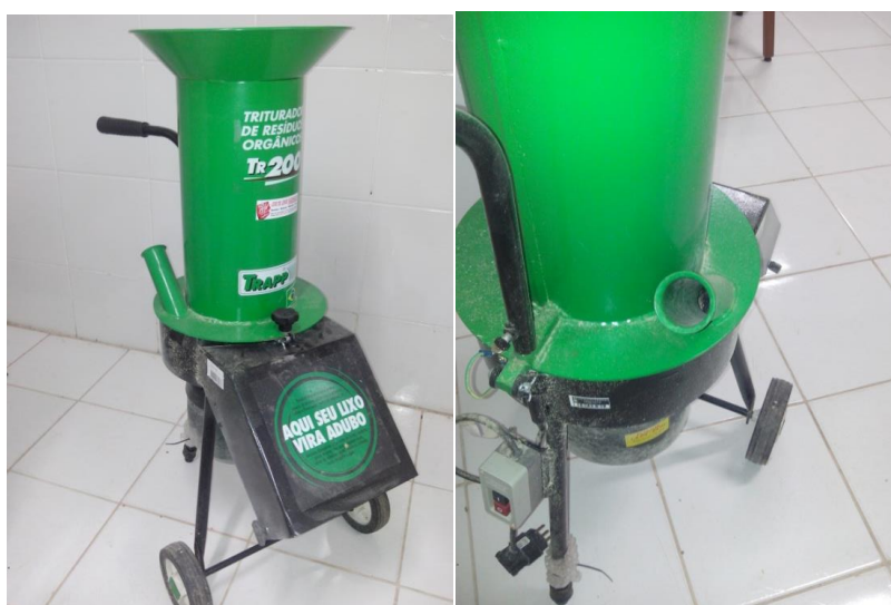
Figura 28 – Triturador utilizado para os colmos do bambu
