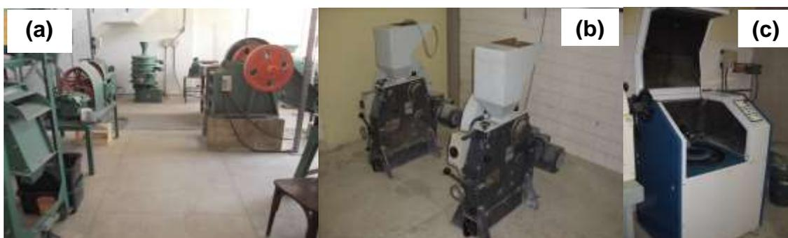
Figura 7.1 – Fotografias dos laboratórios e equipamentos da UFPE: (a) laboratório de preparação de amostras / Departamento de Engenharia de Minas; (b) britadores do laboratório de preparação de amostras LAPA/DGEO (c) fotografia do moinho de discos.
