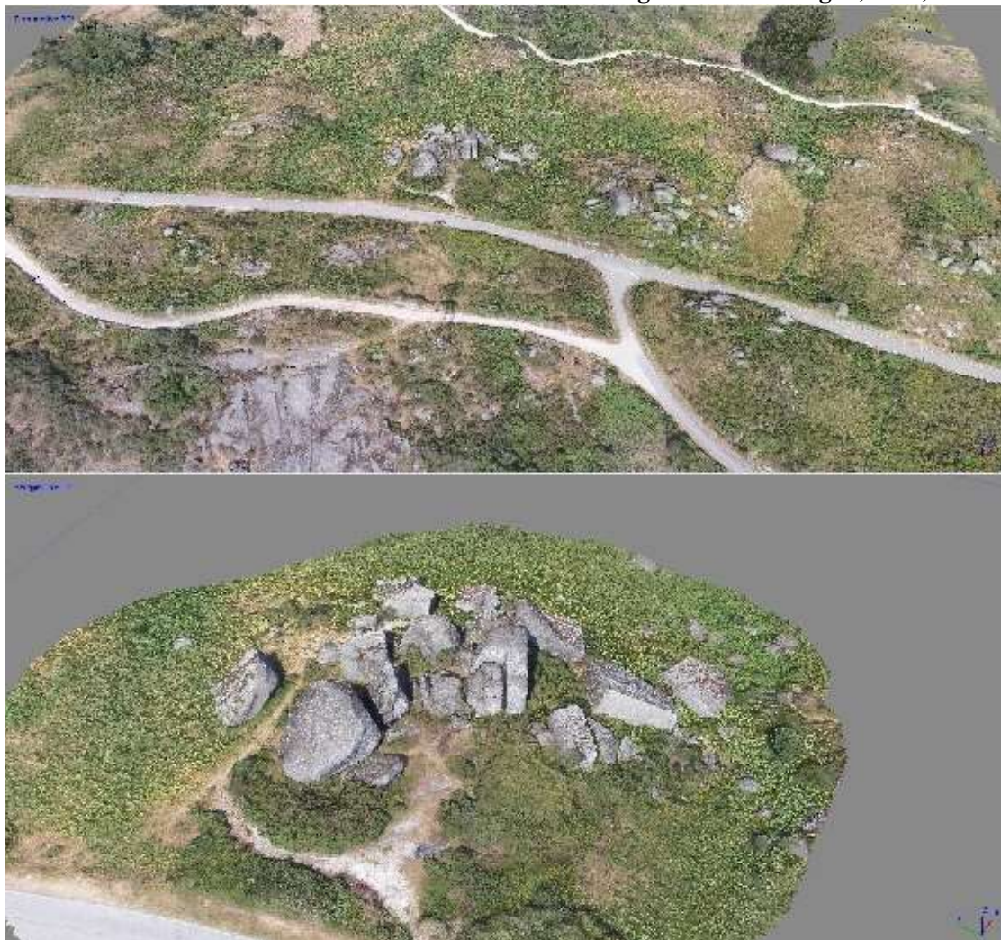
Figura 52. Modelo 3D obtido com voo em grelha para identificação de potenciais estruturas a imagear na área de interesse. Em baixo Caos de Blocos imageado em modo de voo orbital e Modelo tridimensional com Ortofotomosaico dos blocos graníticos de Lagoa, Fafe, Pt.
