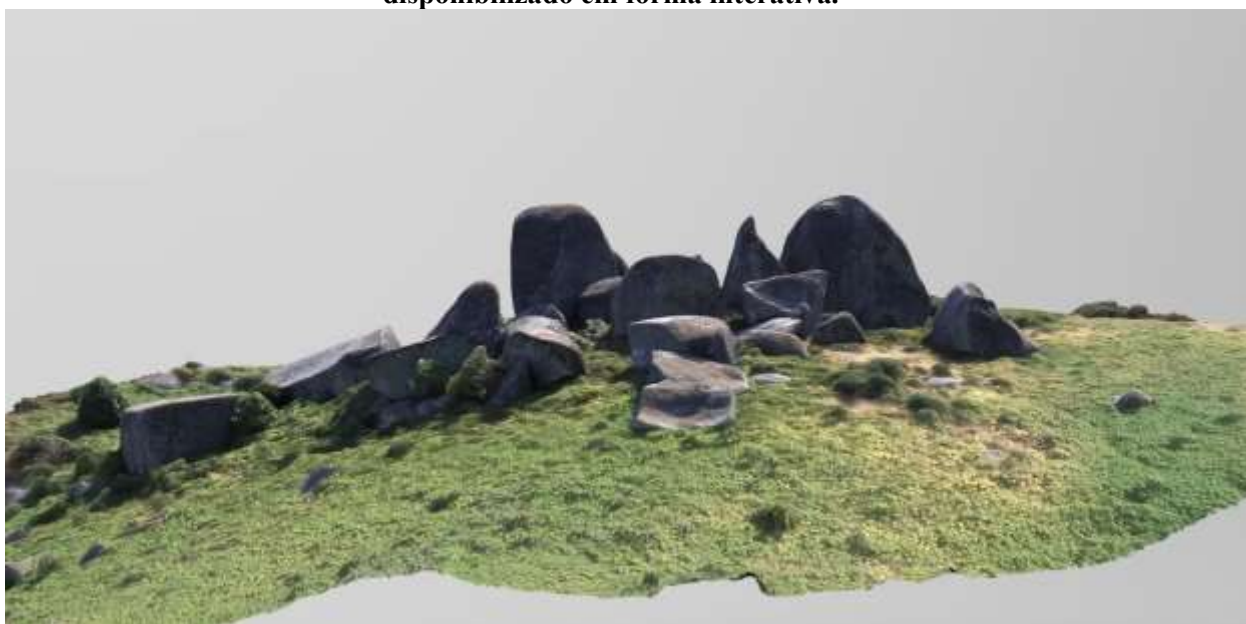
Figura 88. Captura de tela e link de Modelo tridimensional de blocos graníticos obtido através do processamento de imagens geradas utilizando Câmera acoplada ao VANT Walkera e disponibilizado em forma interativa.
