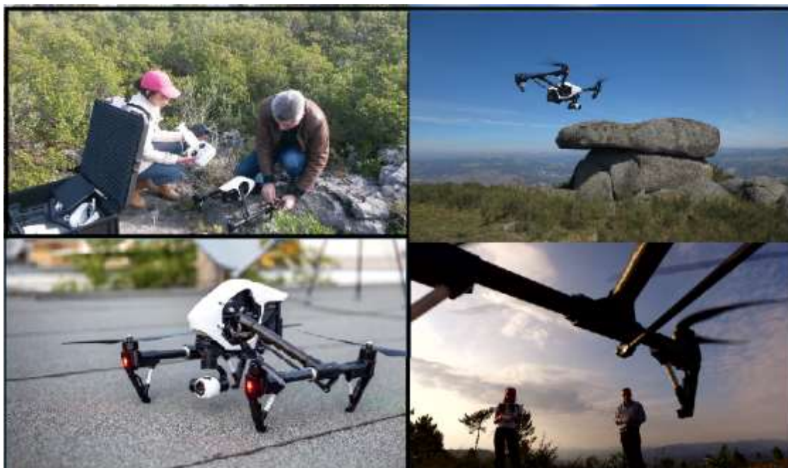
Figura 2. Exemplo de utilização de VANTs para obtenção de dados de imagens, vídeos e modelos digitais de superfície. Pode-se observar a boa resolução da Câmera e a funcionalidade de rotação do conjunto Gimbal/Câmara ainda em processo de pouso. Neste caso, o modelo DJI Inspire 1, acoplado de câmara ZenMuse X3. Concelho de Alvaiázere – Pt, 2015.
