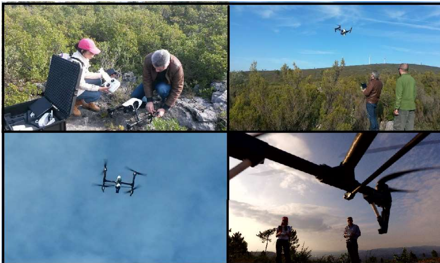
Figura 07- Exemplo de utilização de VANTs para obtenção de imagens panorâmicas, vídeos e modelos digitais de superfície. O equipamento é de fácil utilização e montagem, neste caso o VANT DJI Inspire 1 com câmara própria do VANT acoplada. Pode-se observar a Câmara a tirar fotografias ainda em processo de pouso, Portugal.
