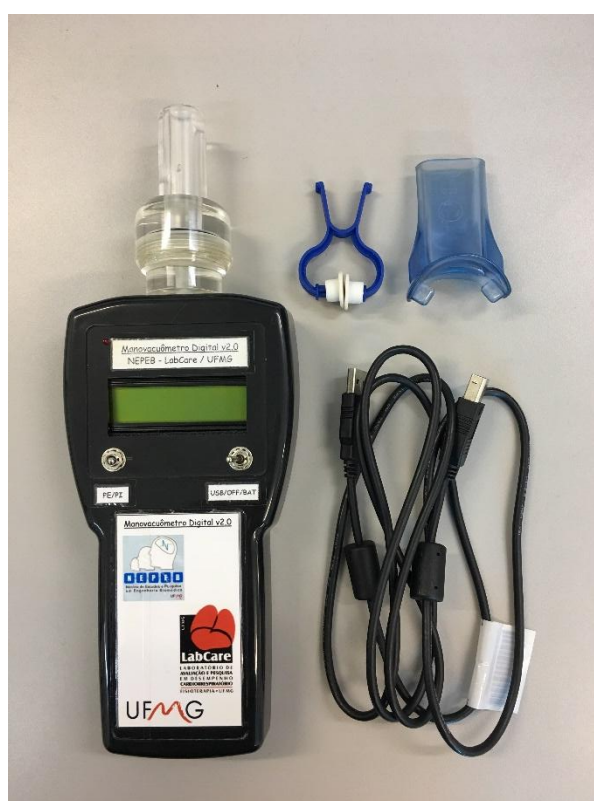
Figura 14: Manovacômetro digital (NEPEB –LabCare/UFMG, Belo Horizonte-MG, Brasil) com peça acrílica, bocal tipo mergulhador e clipe nasal.
