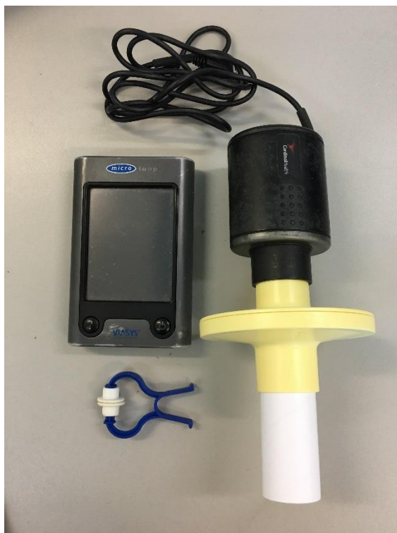
Figura 13 Espirômetro portátil (Micro Medical, Microloop, MK8, Inglaterra) acoplado a um bucal descartável e clipe nasal.
