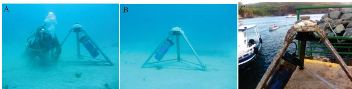
Figura 4 – Procedimento do fundeio do equipamento AWAC (A e B). Equipamento após ter sido retirado da água para manutenção (C).
