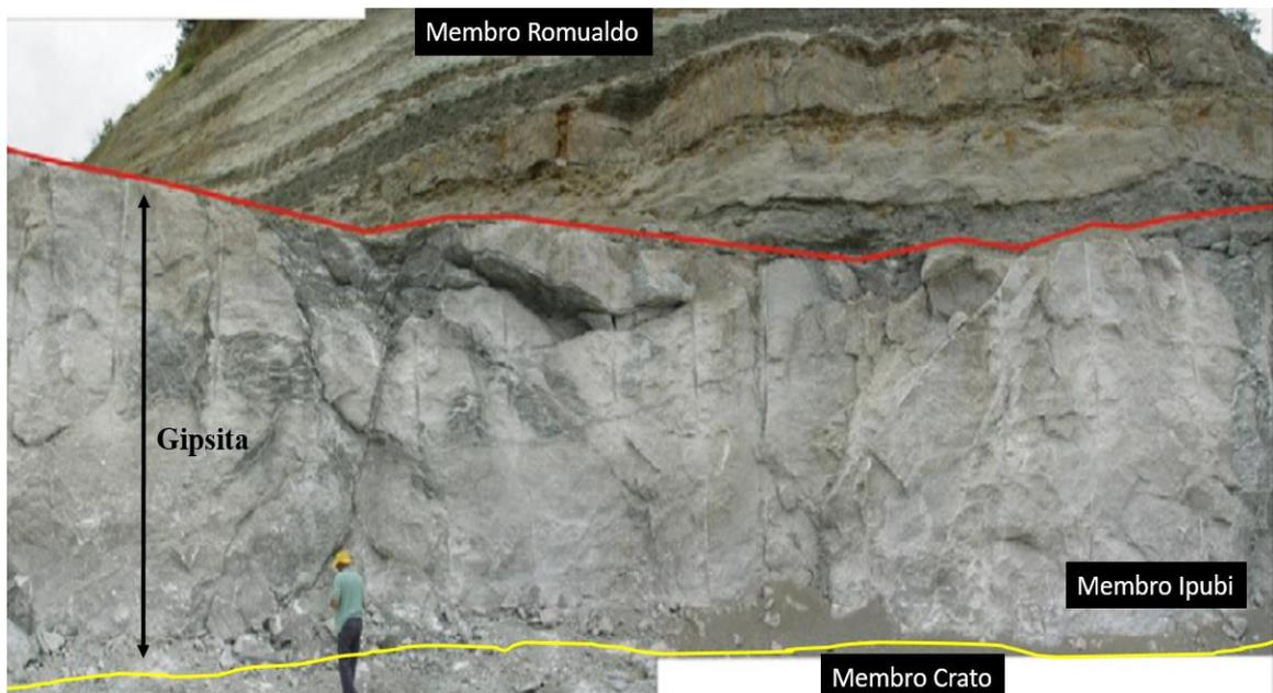
Figura 8 - Frente de lavra de gipsita da Mineradora São Jorge em Ouricuri (PE), indicando o contato entre os membros Romualdo, Ipubi e Crato (adaptado de ALMEIDA, 2010).
