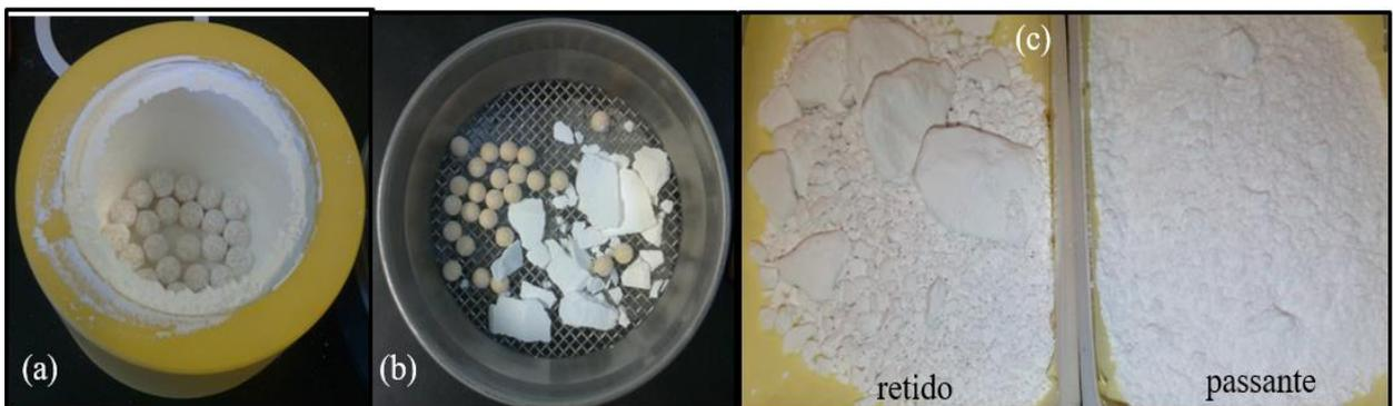
Figura 21 - Vista superior do pote após moagem da gipsita alabastro durante 60 min (a), imagens de fragmentos aglomerados (b) e das frações obtidas após classificação na peneira de 600  $\mu\text{m}$  (c).
