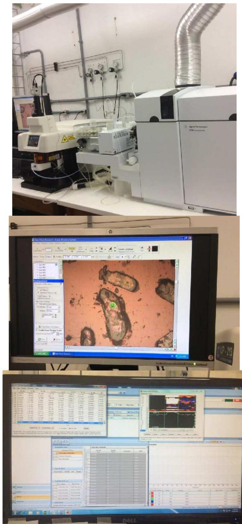
Foto 1.1: A- ICP-QMS (Agilent 7700x) associado a um sistema de laser LUV213 Nd:YAG (NewWaveUP213). B- Planilhas no software GLITTER. C- Posicionamento computadorizado de alta precisão do laser.
