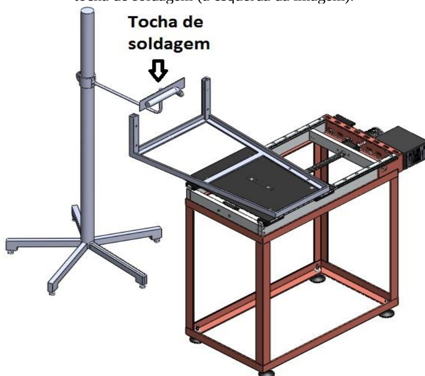
Figura 43– Suporte porta chapa vertical (fixo à mesa com tampo móvel) e base de fixação da tocha de soldagem (à esquerda da imagem).
