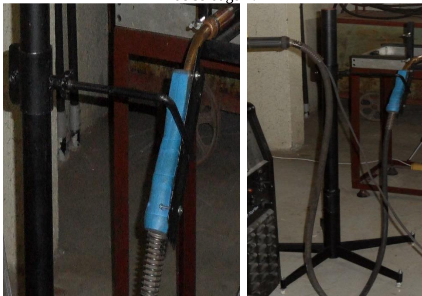
Figura 45– Base de fixação plenamente ajustável às necessidades de posicionamento da tocha de soldagem.
