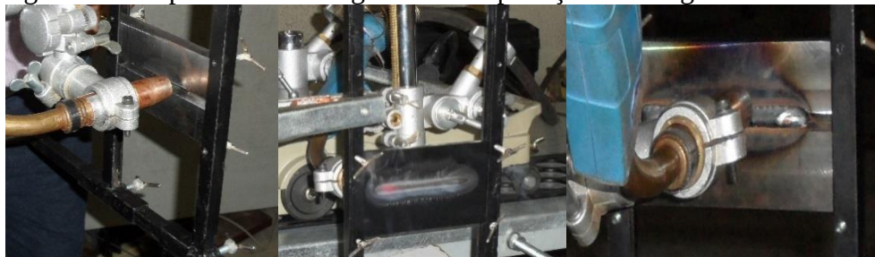
Figura 59 – Suporte vertical regulável em aplicação à soldagem automatizada.
