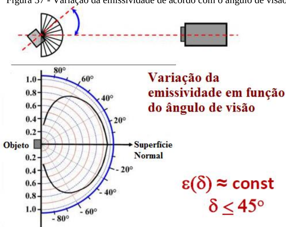
Figura 37 - Variação da emissividade de acordo com o ângulo de visão.
