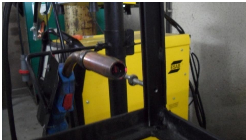
Figura 48 – Alinhamento do laser em relação à tocha.
