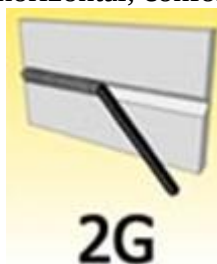
Figura 27 – Posição de soldagem 2G horizontal, conforme norma ASME seção IX (QW461).
