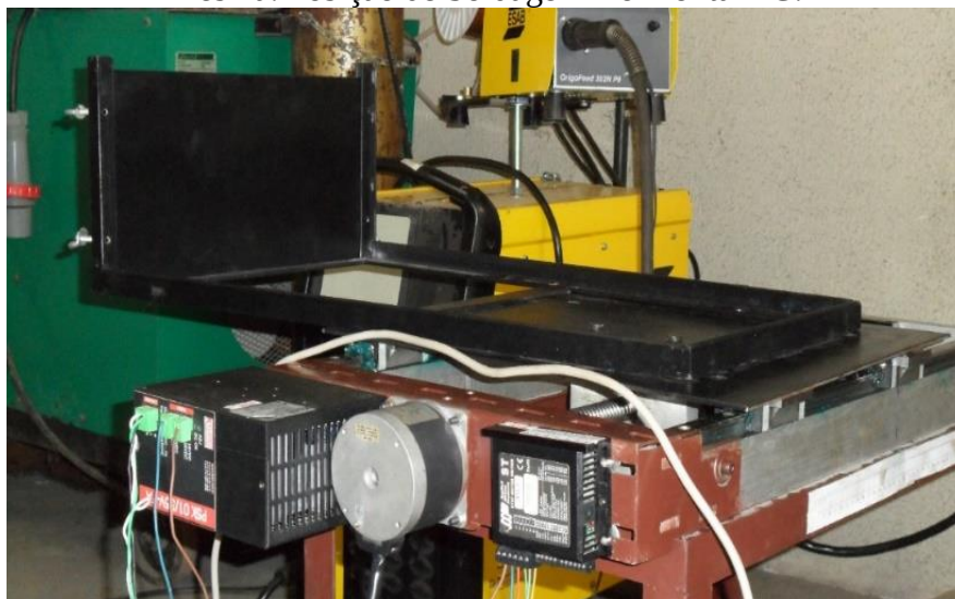
Figura 30 - Etapa 1. Mesa de coordenadas com suporte porta chapa vertical aparafusado à mesma. Posição de Soldagem Horizontal 2G.
