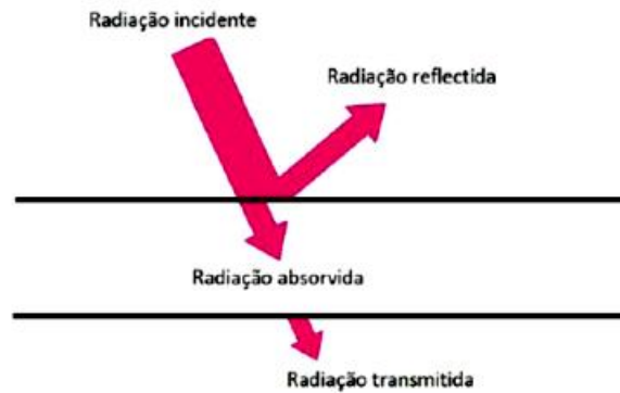
Figura 22 - Balanço de energia radiante para um corpo real.
