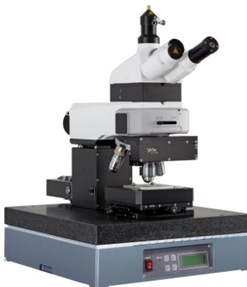
Figura 54: Equipamento de medida de AFM e espalhamento Raman semelhante ao que foi utilizado na pesquisa
