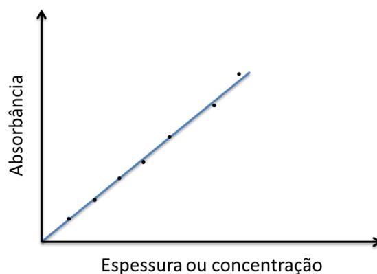
Figura 37: A lei de Beer-Lambert afirma que a absorvância varia linearmente com a espessura do filme, mantendo a concentração constante ou linearmente com a concentração, mantendo a espessura constante.
