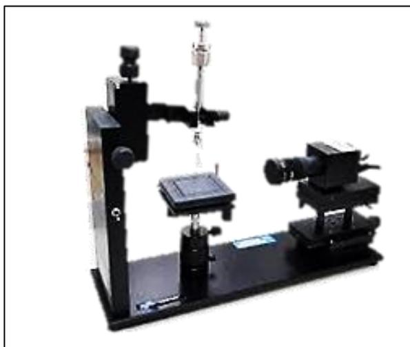
Figura 55: Equipamento de medida de ângulo de contato, semelhante ao que foi utilizado na pesquisa.
