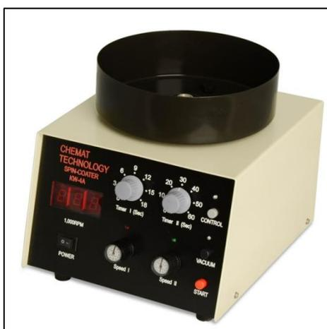
Figura 48: Foto do equipamento de Spin-Coating semelhante ao que foi utilizado para deposição dos filmes de PEDOT:PSS.
