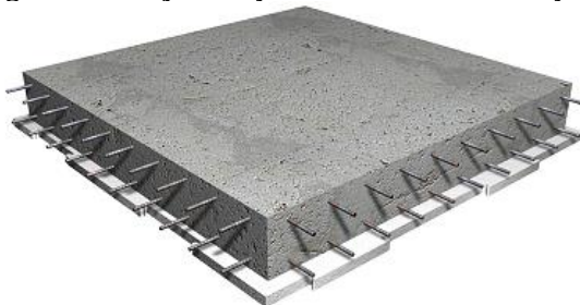
Figura 22 – Laje maciça armada em duas direções.
