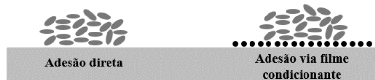
Figura 1. Adesão bacteriana primária direta e via filme condicionante em uma superfície sólida. O filme condicionante é formado pela deposição de materiais orgânicos ou inorgânicos na superfície do material.
