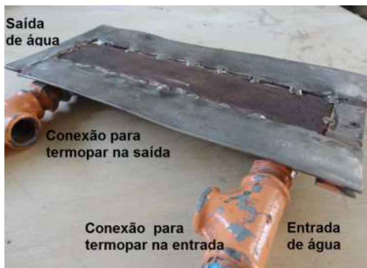
Figura 25 – Detalhe do calorímetro de fluxo mássico de água.
