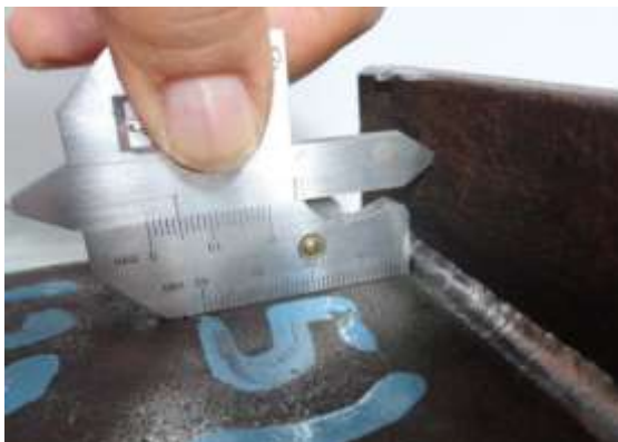
Figura 43 - Medição da perna dos filetes na direção horizontal
