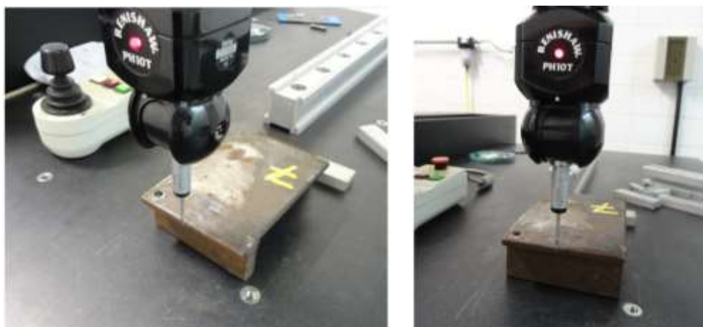
Figura 91- Medição na MMC das amostras de chapas após a linha de calor
