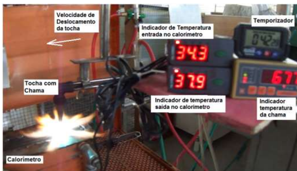
Figura 28 – Detalhe do calorímetro para determinar a quantidade de calor.
