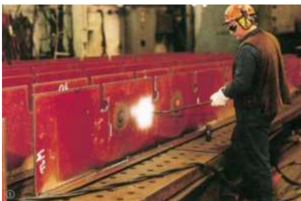
Figura 1- Aplicação de linhas de calor para correção durante a fabricação.
