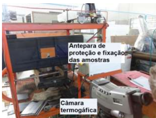
Figura 30- Detalhe da utilização da câmara termográfica.
