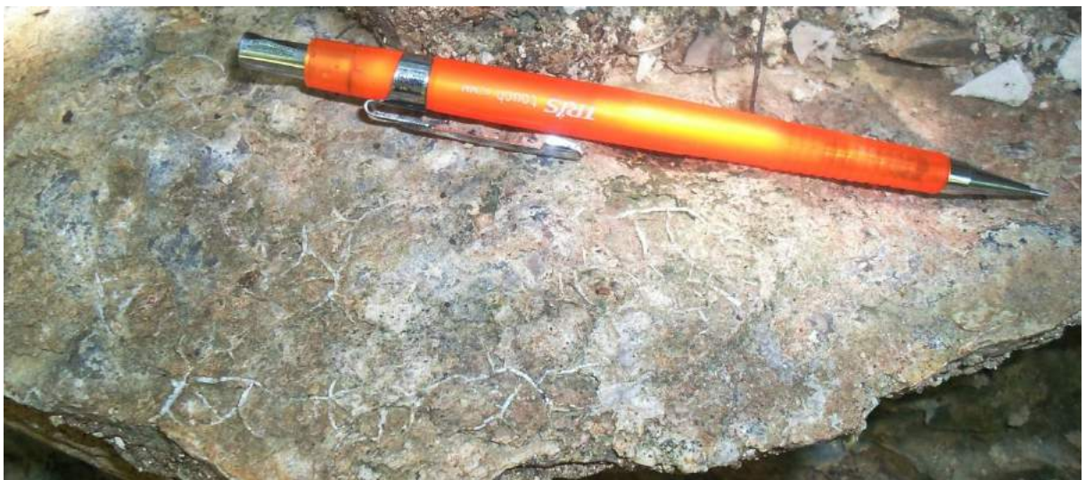
Figura 12 – Afloramento próximo a Mina Conceição Preta exibindo várias microfraturas preenchidas por calcita (AFL 02).
