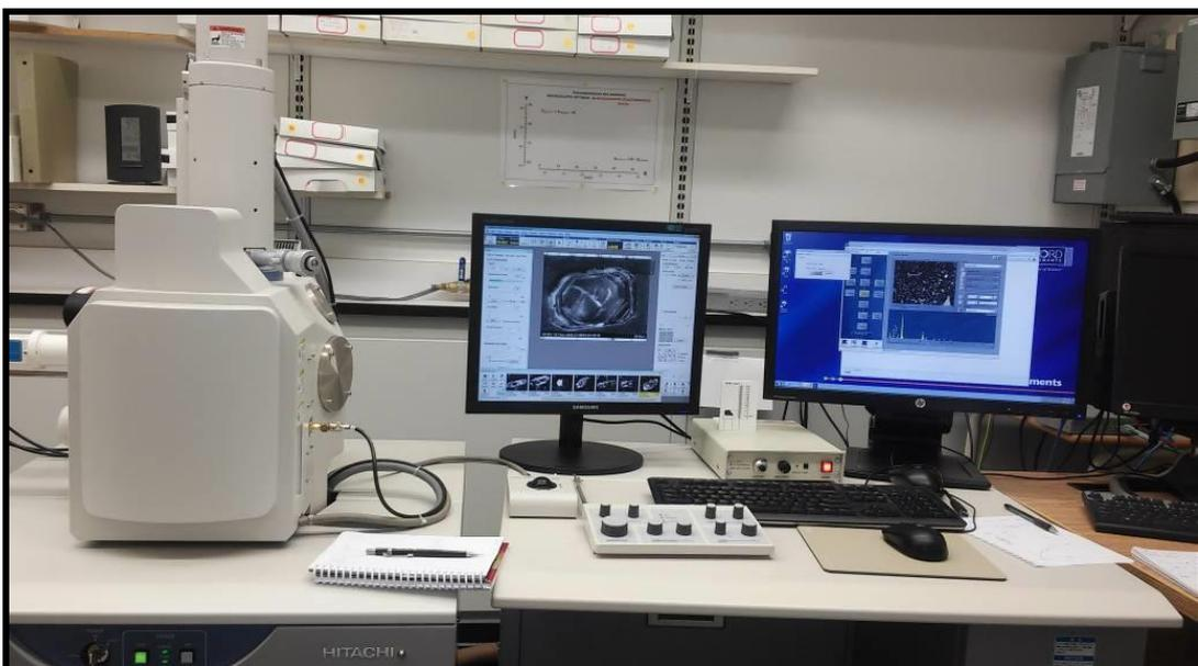
**Figura 06.** Imagem do MEV acoplado a catodoluminescência, equipamento utilizado para análises das estruturas internas dos zircões.
