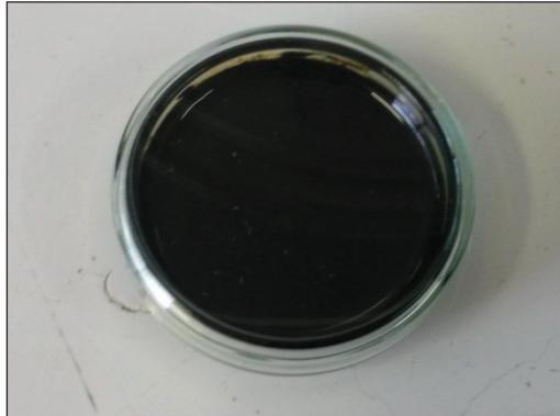
A cada 30 dias as amostras foram retiradas para análise de Microscopia Ótica para avaliação do efeito corrosivo do petróleo cru na superfície das cerâmicas. Ao fim dos 90 dias, as amostras passaram também por novos ensaios de microdureza Vickers e de DRX.
