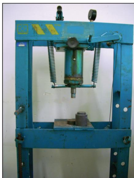
A figura 3.4 (a) mostra a matriz cilíndrica onde é contendo a mistura a ser prensada, respeitando a máxima capacidade do equipamento (15 toneladas). Com base nas composições, foram confeccionados corpos de provas (pastilhas) no formato de discos com diâmetro  $\varnothing 30$  mm, Figura 3.4 (b) apresenta um dos corpos de prova a verde.
