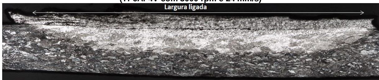
Figura 4.28 – Largura ligada dos revestimentos descentralizada em relação à largura nominal (Ti-6Al-4V com 3000 rpm e 24 mm/s)
