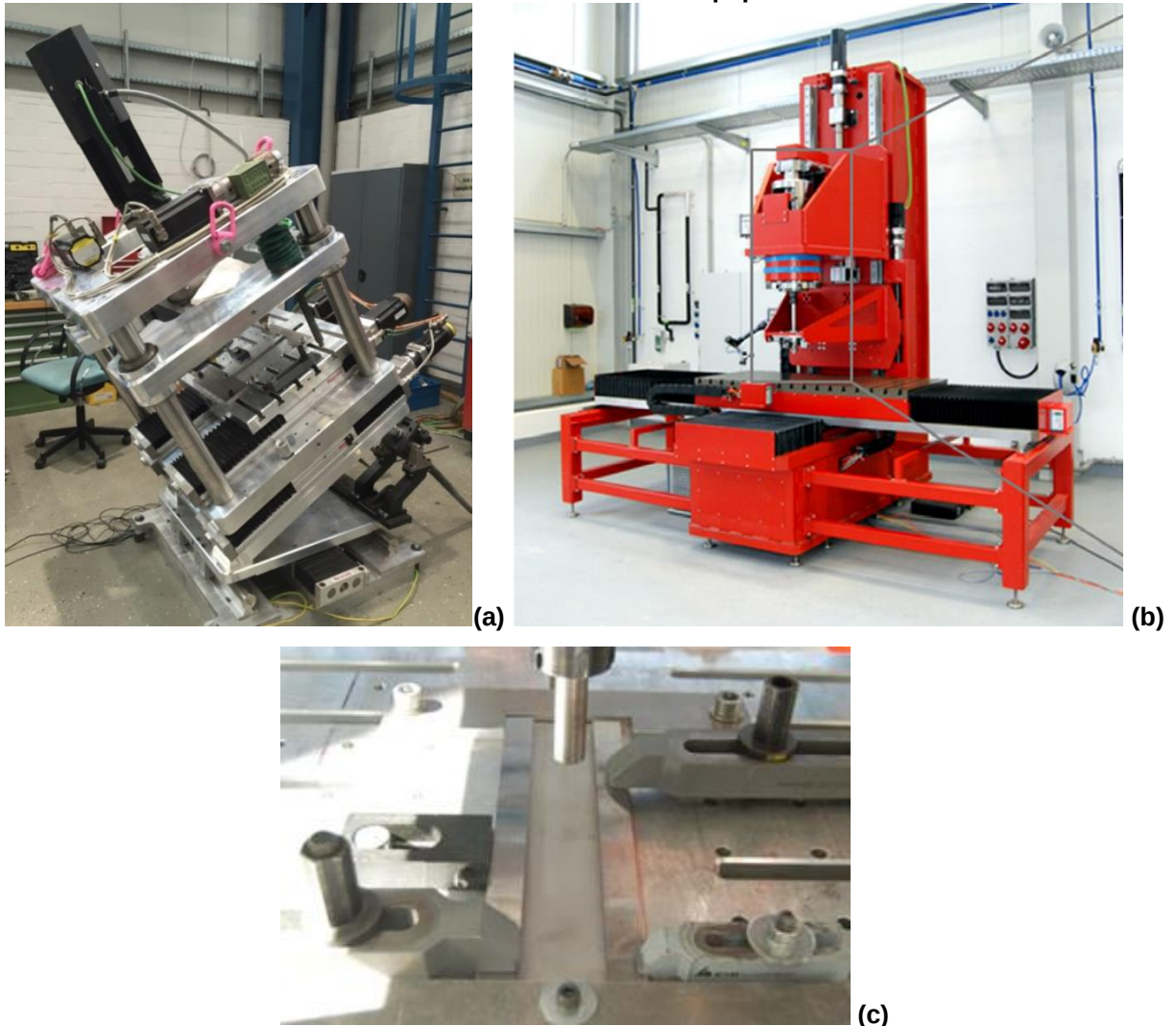
Figura 3.2 - (a) Equipamento para aplicação de revestimentos depositados por atrito, (b) equipamento típico utilizado no processo de deposição por atrito e (c) sistema de fixação do substrato e do consumível ao equipamento
