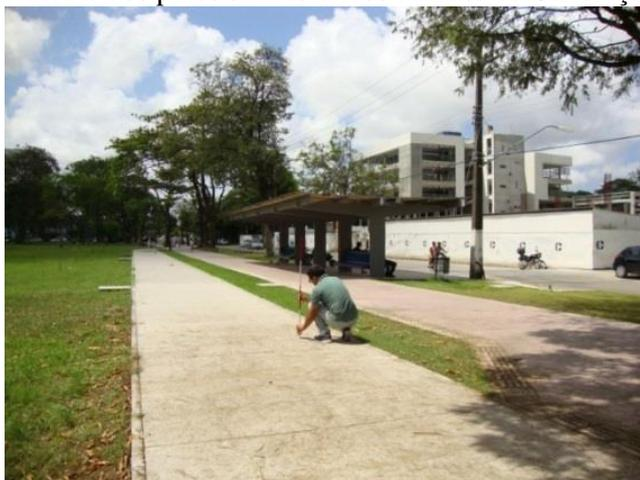
Os procedimentos para a implantação seguiram as recomendações contidas na Norma Internacional ISO 17123 – parte 2 (2001). A base de calibração tem 60 m de comprimento, subdividida em trechos de 10 m. Foram implantados 4 pinos com superfícies semiesféricas a cada 20 m, denominados RN (A, B, C e D) e 3 pontos auxiliares (E1, E2 e E3) com pregos cravados equidistantes entre os pontos A e B, B e C, C e D, respectivamente.
