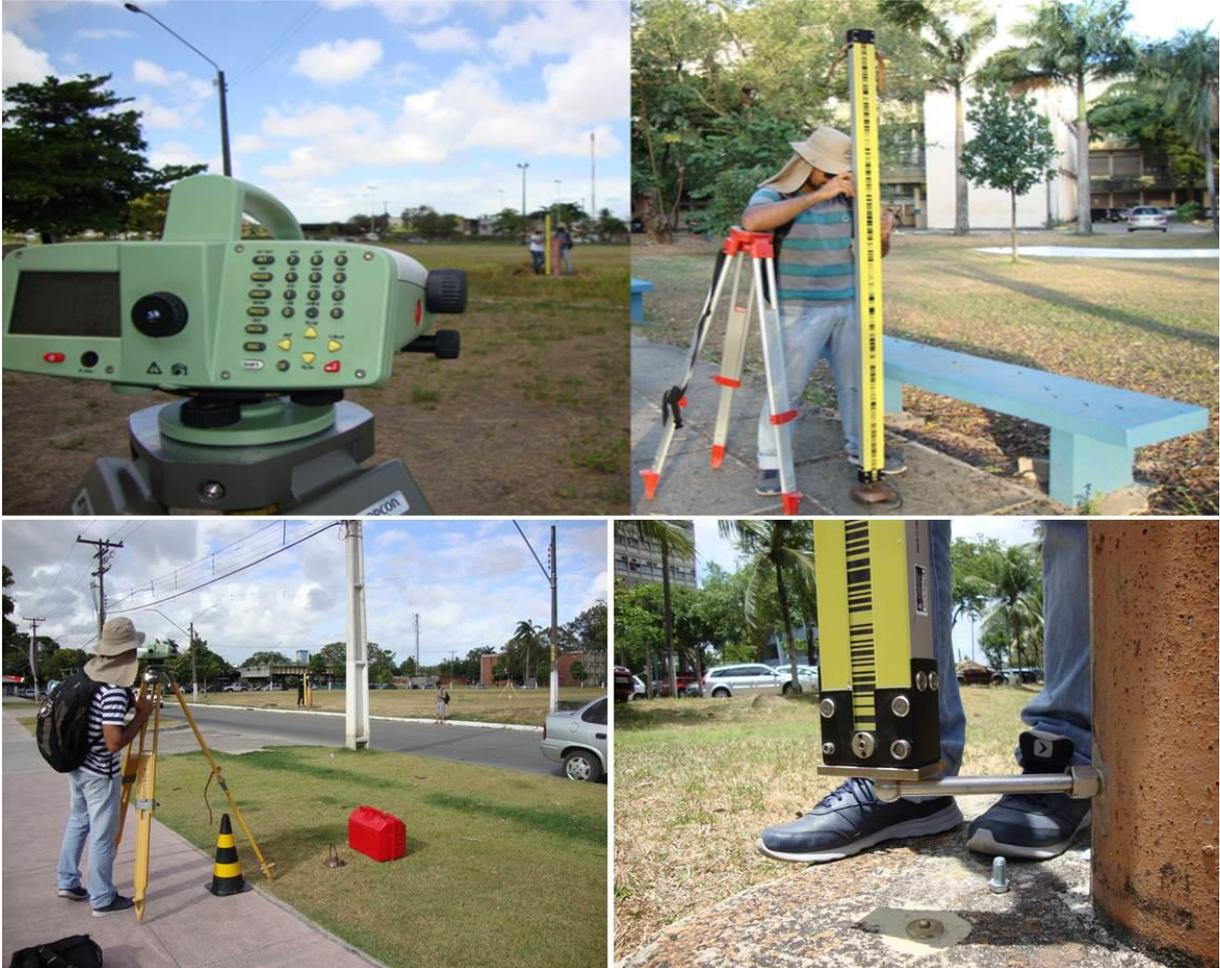
O nível DNA 03 foi configurado para realizar para cada medição (de ré e vante) 4 leituras sucessivas, sendo verificado as respectivas amplitudes para cada grupo de leituras e respectivas médias. Adotando-se uma amplitude menor ou igual á  $\pm 0,06\text{mm}$  para as 4 leituras sucessivamente realizadas. Nas medições o nível digital foi colocado equidistante entre as miras de ré e vante.
