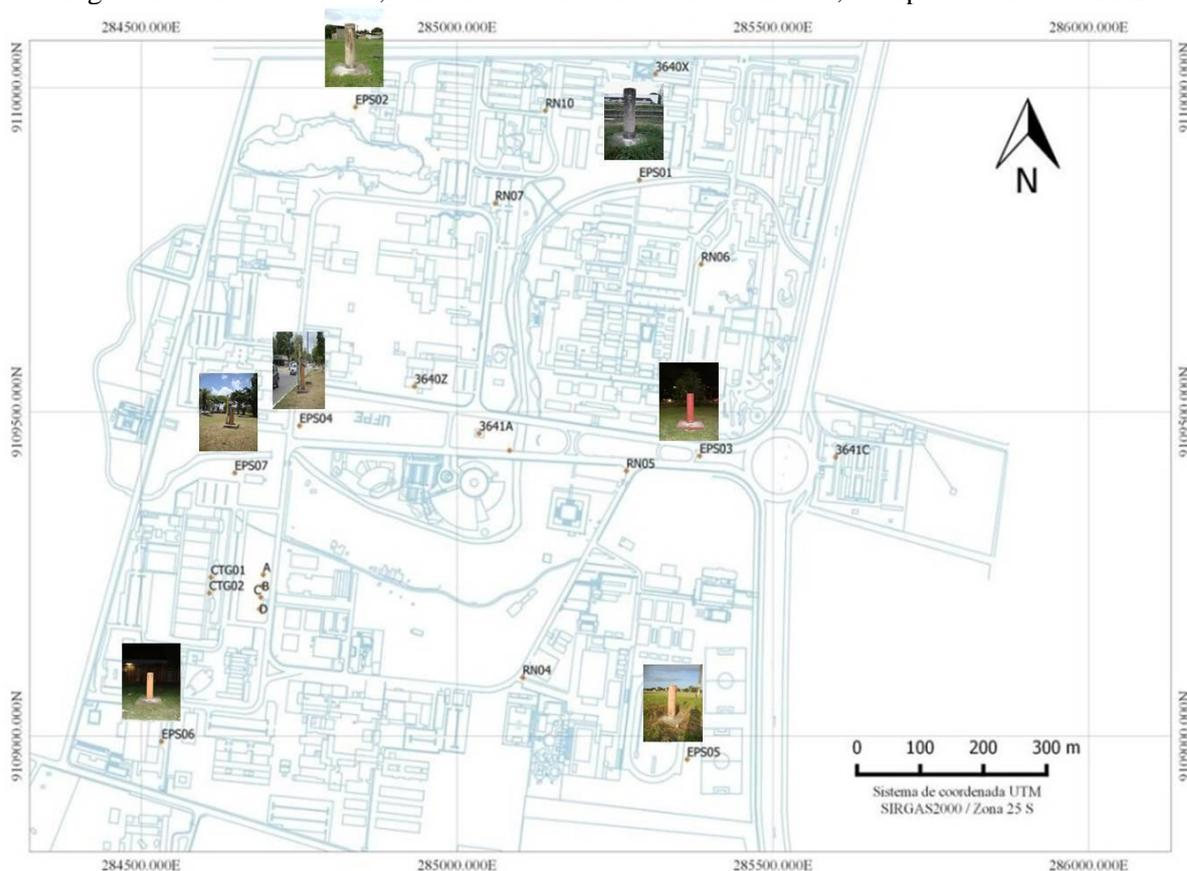
Nas bases dos pilares da RRC foram fixados pinos de superfícies semiesféricas denominados de RNEPS01, RNEPS02, RNEPS03, RNEPS04, RNEPS05, RNEPS06 e RNEPS07 utilizados como Referências de Nível e nos pilares da RRC foram fixados parafusos denominados de: P-EPS01, P-EPS02, P-EPS03, P-EPS04, P-EPS05, P-EPS06 e P-EPS07.
