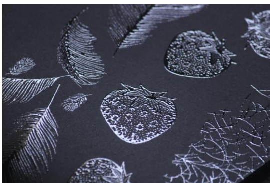
Figura 16 - Aplicação de verniz localizado.
