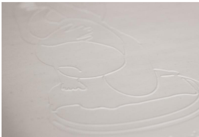
Figura 17 - Impressão em relevo utilizando clichê.
