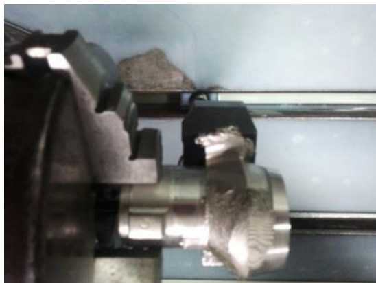
Figura 23. Adaptador externo durante processo de usinagem.
