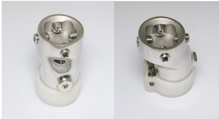
Figura 24. Adaptador externo após o processo de usinagem.
