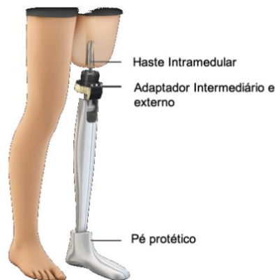
Figura 5 Componentes de uma prótese osseointegrada convencional.
