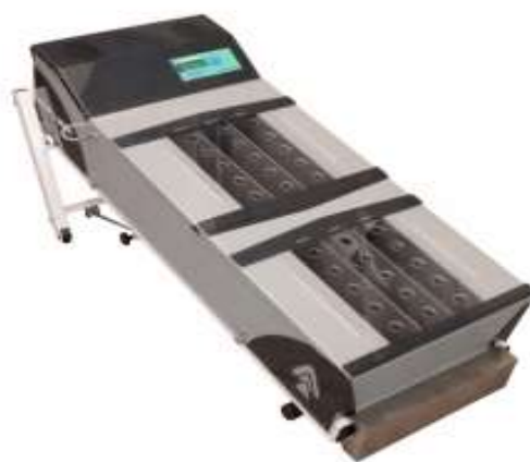
Figura 2- Visão diagonal do aparato de teste máximo em esteira.
