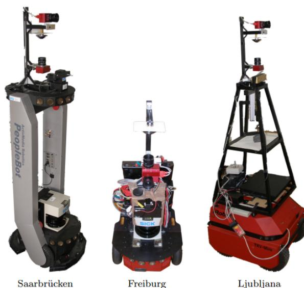
**Figura 4.3:** Plataformas robóticas utilizadas na aquisição das sub-bases. ActivMedia PeopleBot na COLD-Saarbrücken, ActivMedia Pioneer-3 na COLD-Freiburg e iRobot ATRV-Mini na COLD-Ljubljana. ([Pronobis e Caputo, 2009](#))
