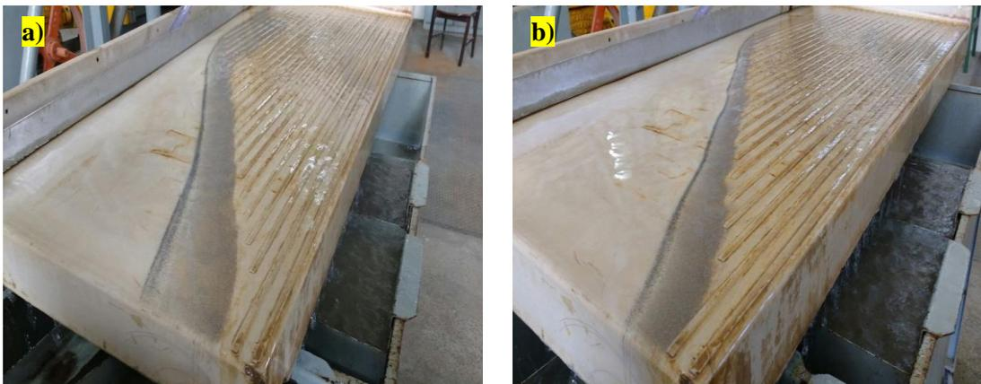
Figura 38 - Perfil do ensaio 4 com amplitude 12 mm (a) e do ensaio 8 com amplitude de 14 mm (b)
