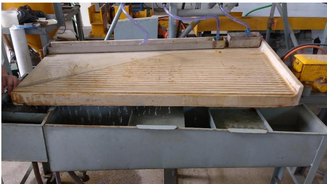
Figura 23 - Mesa oscilatória utilizada para os ensaios
