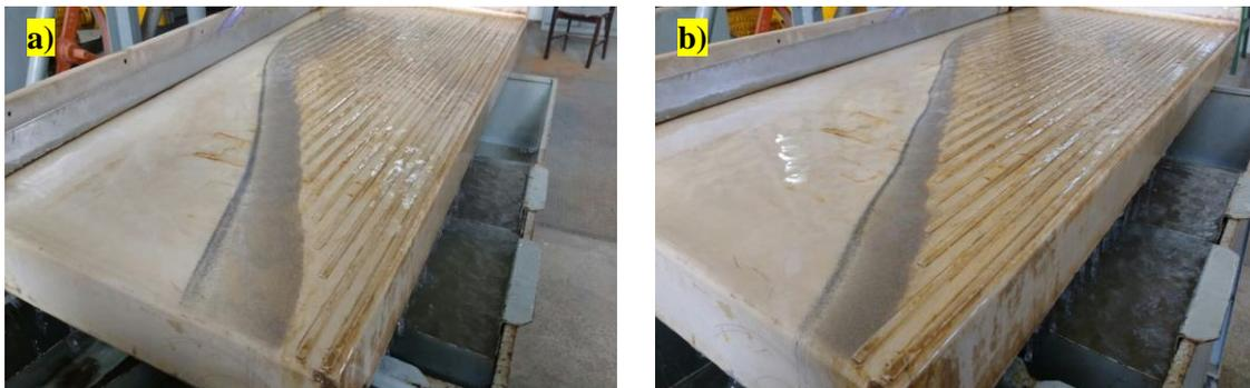
Figura 49: Perfil do ensaio 4 com amplitude 12 mm (a) e do ensaio 8 com amplitude de 14 mm (b)
