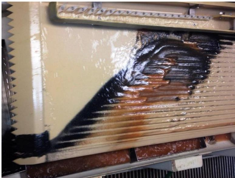
Figura 18 - Ensaio com baixas vazões de água de limpeza na concentração de hematita
