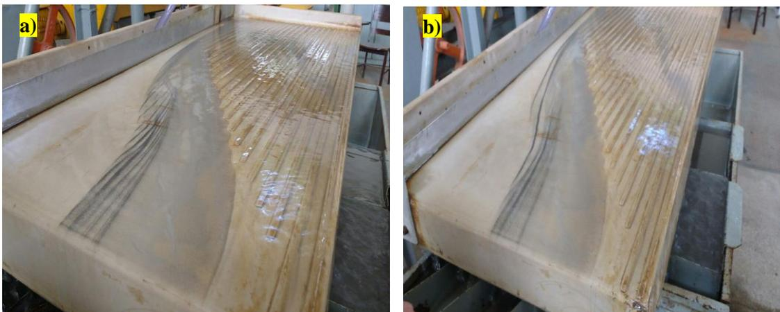
Figura 35 - Perfil do ensaio 1 com amplitude de 12 mm (a) e do ensaio 5 com amplitude de 14 mm (b)
