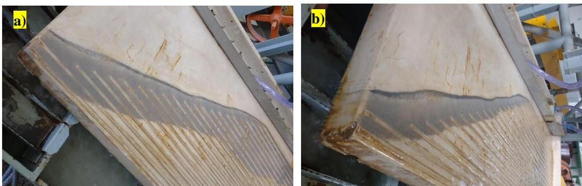
Figura 44: Perfil de separação no ensaio 4 (a) e ensaio 8 (b) para as condições de amplitude 12 mm e 14 mm, respectivamente
