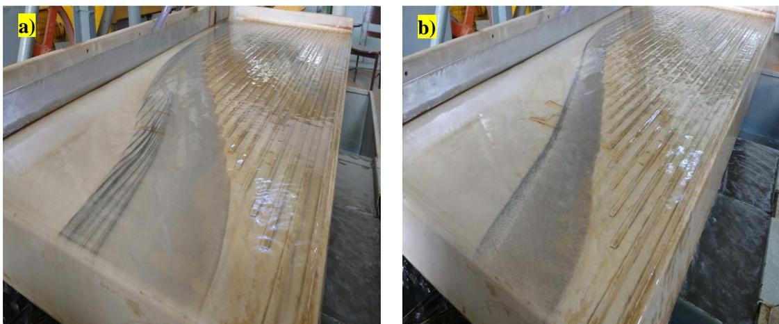
Figura 42 - Perfil de separação no ensaio 1 (a) e ensaio 2 (b) para as condições de granulometria fina e granulometria grossa
