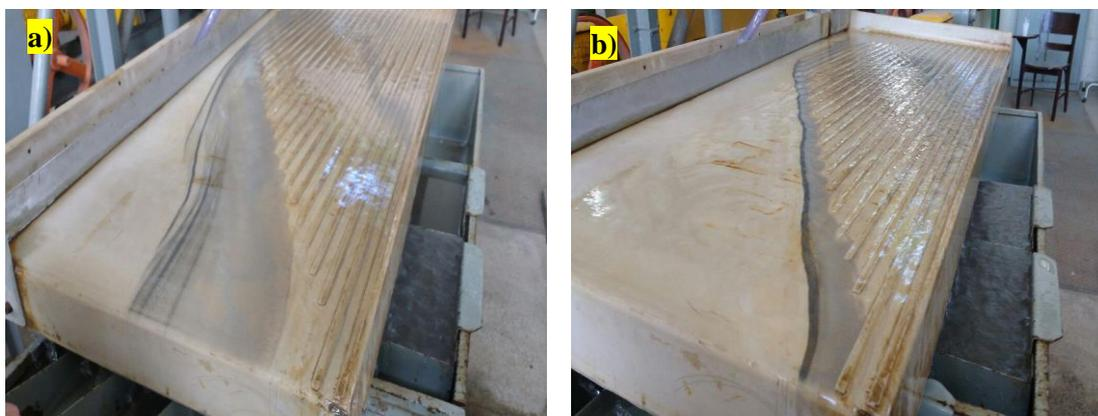
Figura 43: Perfil de separação no ensaio 5 (a) e ensaio 7 (b) para as condições de inclinação 2° e 4°, respectivamente
