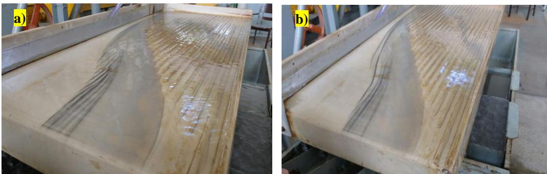
Figura 46: Perfil do ensaio 1 com amplitude de 12 mm (a) e do ensaio 5 com amplitude de 14 mm (b)
