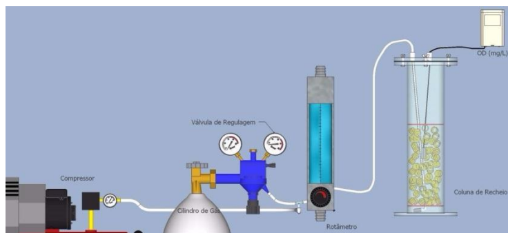
Figura 1: Descrição esquemática da montagem experimental da coluna borbulhamento/recheada.
