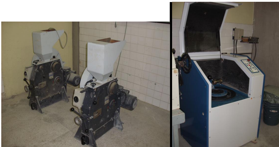
Figura 5.1 - Fotografias ilustrando equipamentos. (A) britadores, (B) moinho com disco de chumbo.
