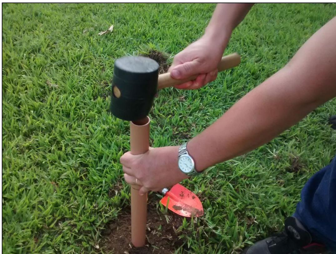
Figura 45 - Amostragem de coluna de solo para ensaio de difusividade de ^{222}\text{Rn}
