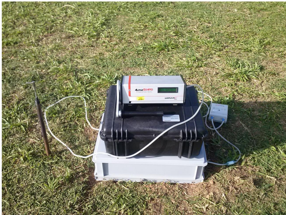
Figura 56 – Sistema de detecção utilizando a câmara RadonBOX para a determinação da emissão de ^{222}\text{Rn} em campo.
