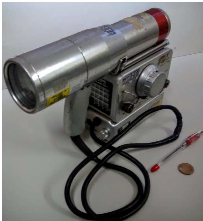
Figura 53 - Cintilômetro SAPHYMO, modelo SRAT-SPP/2, utilizado para seleção dos pontos de estudos.
