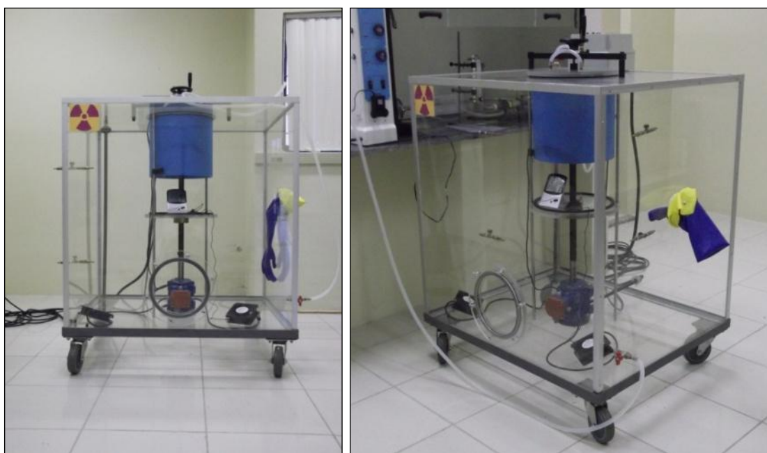
Figura 20 - Câmara de calibração construída no CRCN-NE.
