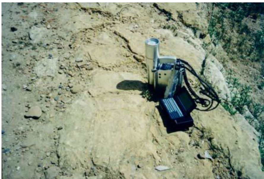
Figura 3- Afloramento de fosforito uranífero encontrado por Souza (2006) no Bairro de Paratibe, Município de Paulista (PE) utilizando um cintilômetro portátil.
