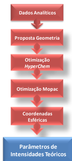
Figura 49: Esquema simplificado mostrando as etapas de otimização e obtenção dos parâmetros de intensidade teóricos dos complexos em estudo.
