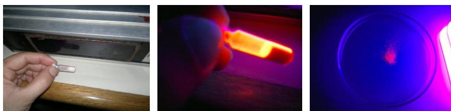
Figura 21: Complexo [\text{Eu}(\text{Fen})(\text{Ox})_2(\text{H}_2\text{O})_3]\text{Cl} sem excitação da radiação de ultra-violeta (direita). Emissão do complexo [\text{Eu}(\text{Fen})(\text{Ox})_2(\text{H}_2\text{O})_3]\text{Cl} (centro) e do complexo [\text{Eu}(\text{tiofen-Pir})_2(\text{Fen})(\text{H}_2\text{O})_3]\text{Cl} (esquerda).
