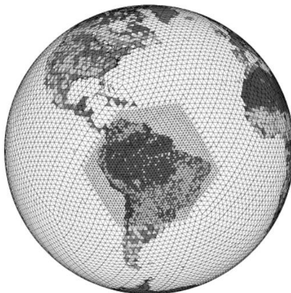
Figura 23 – Malha do modelo numérico de previsão OLAM.
