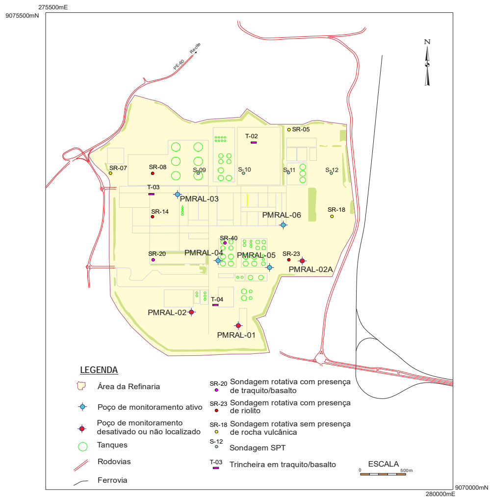
Figura 19 - Mapa com as posições das sondagens rotativas, SPT e trincheiras.
