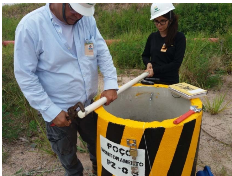
Figura21- Slug utilizado nos testes dos poços da RNEST (poço PMRAL-04).
