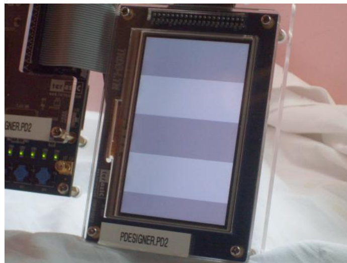
Figura 48: Padrão de barras verticais gerado pela câmera e exibido no display de LCD do kit .
