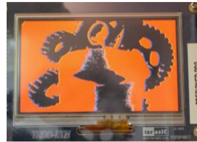
(c) Imagem limiarizada na cor vermelha e identificação dos pontos de transição.
