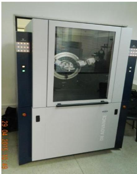
O resultado deste ensaio será um gráfico com das intensidades (contagem/s) pela distância basal. O Quadro 3.1 pode ser usado como referência para a análise mineralógica dos resultados da difração de raio-X.
