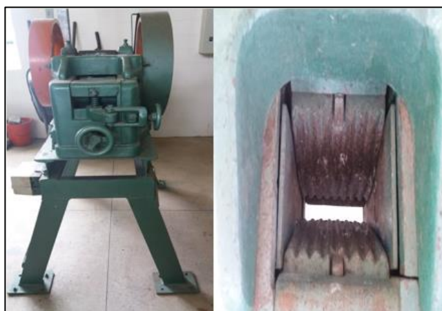
Figura 17 - Britador de mandíbula de um eixo da DENVER.
