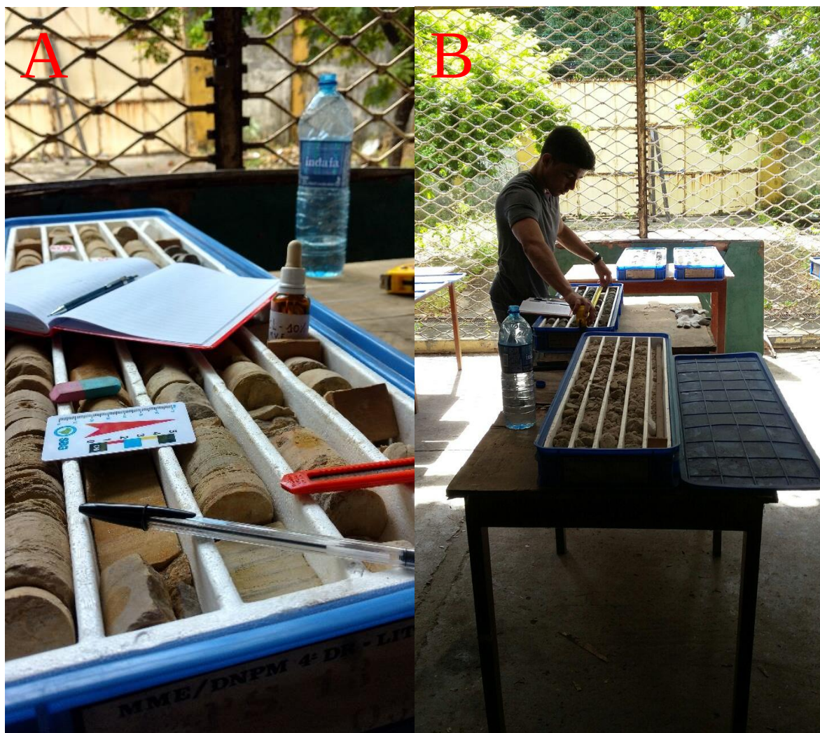
Figura 2 - Atividades dos processos descritivos dos testemunhos: A – caixa de testemunhos; B – espaço para descrições na Litoteca do 4º Distrito do DNPM/Recife.
