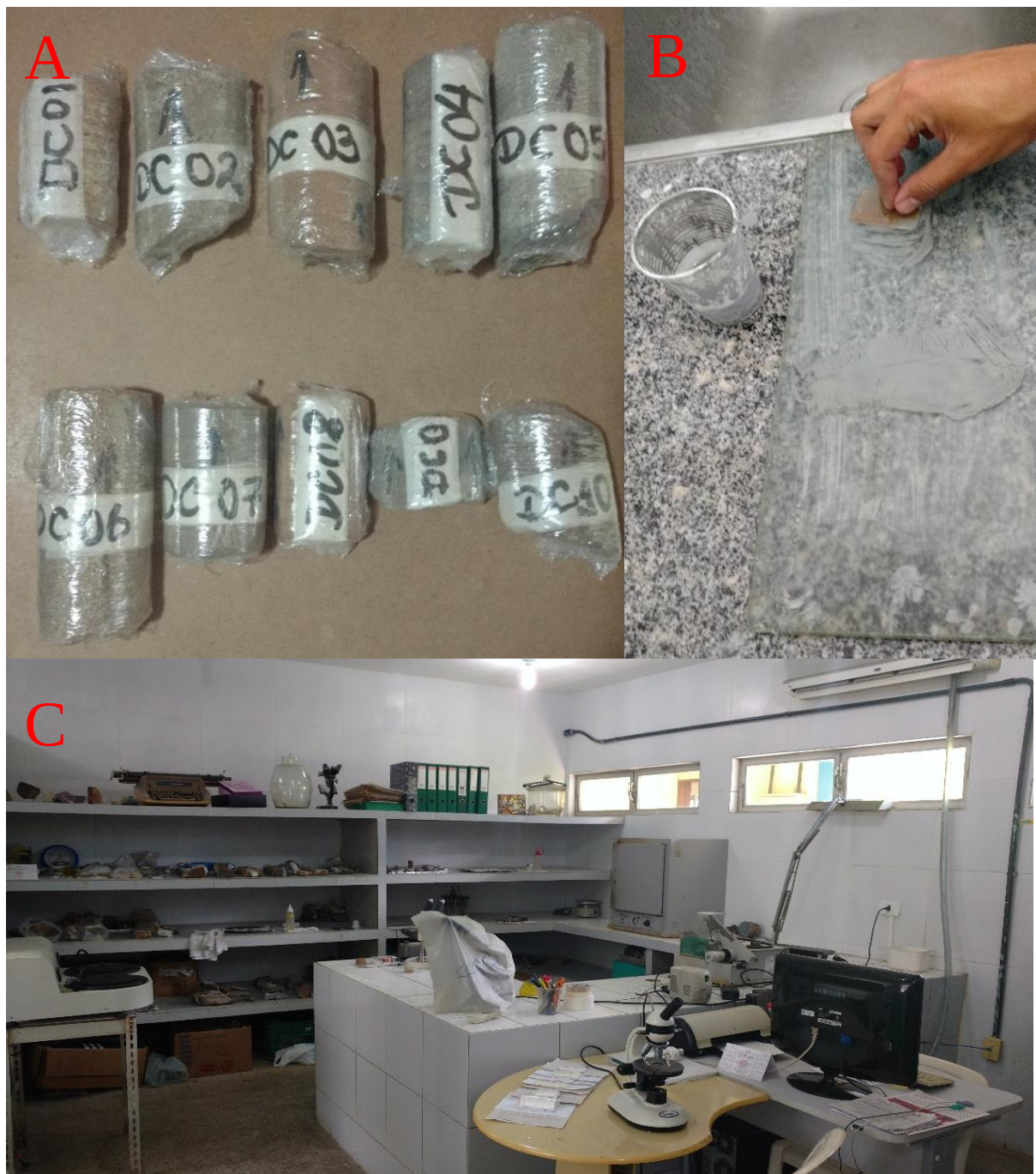
Figura 3 – A - Amostras coletadas para confecção de lâminas petrográficas; B – Processo de polimento das lâminas petrográficas; C - Laboratório de Preparação de Amostras e Laminação – DGeo – CTG.
