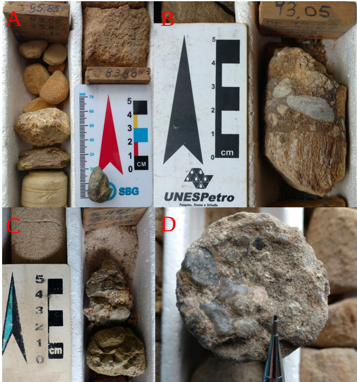
Figura 10 - Exemplos da Fácies Conglomerado maciço (Cm). Legenda: A – PS04CE ~ 95,85m; B – PS10CE ~ 93,05m; C – PS14CE ~ 120,75m; D – PS14CE ~ 136,00m.
