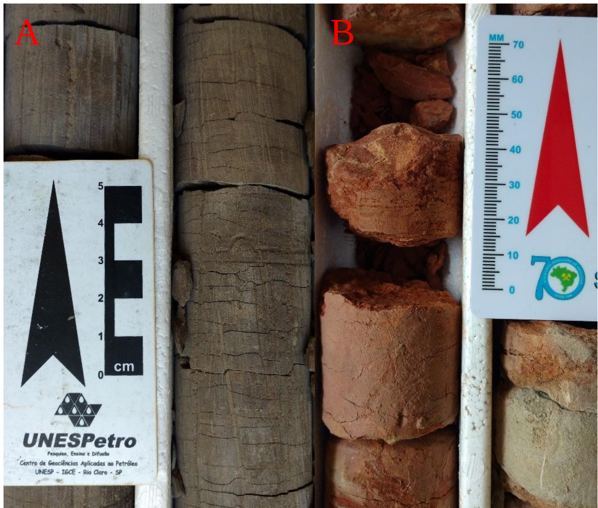
Figura 18 - Exemplos da Fácies Argilito Maciço (Arm). Legenda: A – PS10CE ~ 33,00m; B – PS13CE ~ 89,00m.
