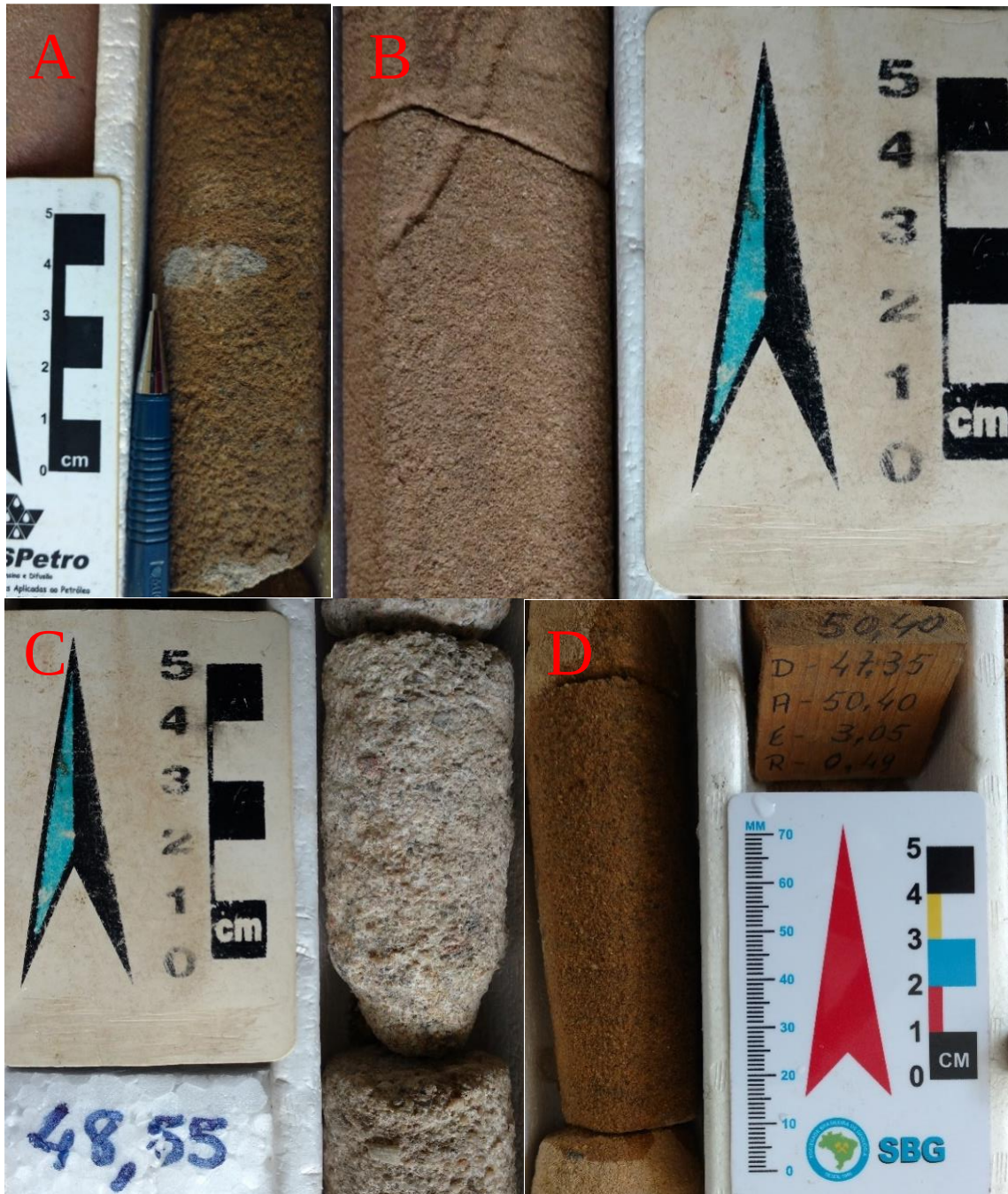
Figura 13 - Exemplos da Fácies Arenito maciço (Am). Legenda: A – PS10CE ~ 78,00m; B – PS14CE ~ 148,00m; C – PS01CE ~ 45,00m; D – PS04CE ~ 62,50m.
