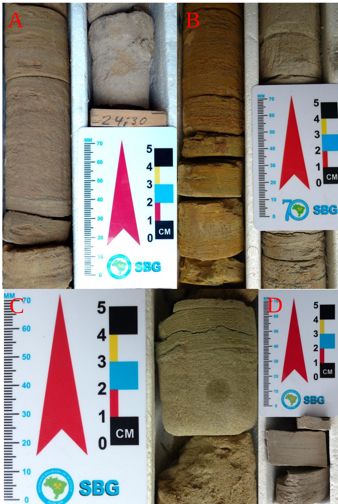
Figura 17 - Exemplos da Fácies Argilito Laminado (Arl). Legenda: A – PS03CE ~ 25,00m; B – PS13CE ~ 142,00m; C – PS06CE ~ 77,00m; D – PS04CE ~ 99,00m.
