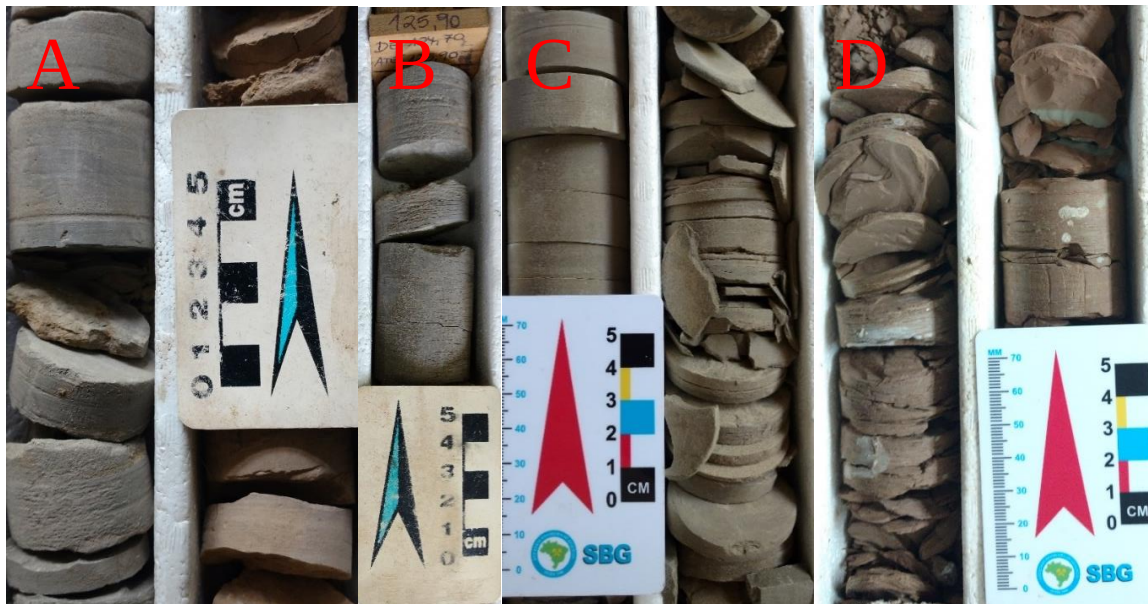
Figura 16 - Exemplo da Fácies Siltito laminado (Sl). Legenda: A – PS03CE ~ 29,00m; B – PS14CE ~ 125,90m; C – PS06CE ~ 84,00m; D – PS07CE ~ 85,00m.
