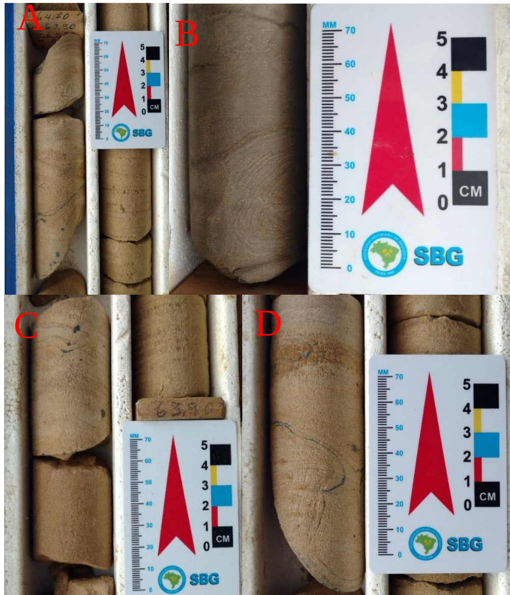
Figura 15 - Exemplos da Fácies Arenito com estruturas deformadas (Ad). Legenda: A – PS13CE ~ 64,60m; B – PS07CE ~ 80,00m; C – PS13CE ~ 65,00m; D – PS13CE ~ 128,00m.
