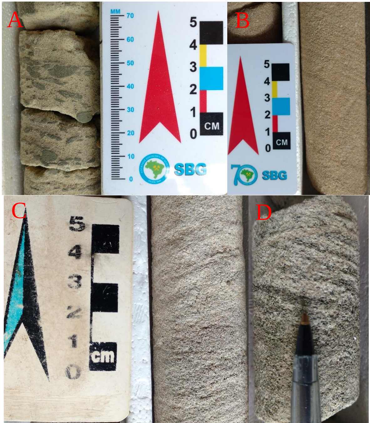
Figura 11 - Exemplos da Fácies Arenito com laminação cruzada (Ac). Legenda: A – PS07CE ~ 67,00m; B – PS13CE ~ 150,00m; C – PS01CE ~ 27,70m; D – PS01CE ~ 15,00m.
