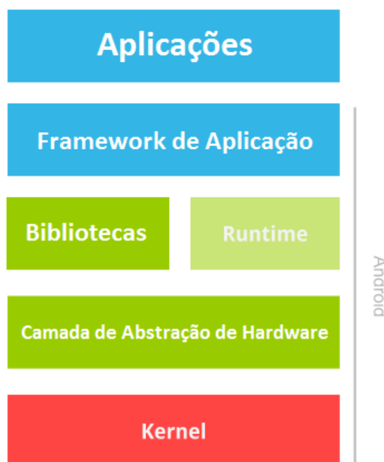
Figura 2.3: Diversos níveis da infraestrutura do Android. Figura retirada de http://mihasoftware.com/2014/02/android-new-runtime/ .
