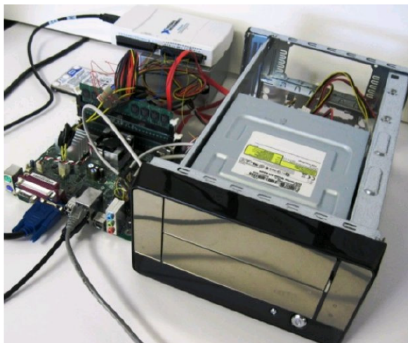
Figura 2.2: Ambiente utilizado para medir o consumo utilizando um DAQ ( Data Acquisition System ). Figura retirada de PETERSON et al. (2011) .
