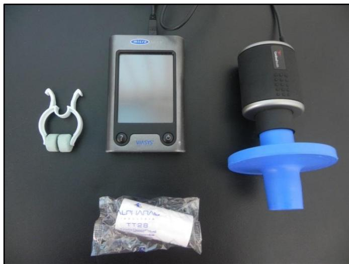
**Figura 5** - Espirômetro Micromedical Microloop MK8 (Fonte: Acervo do laboratório)
