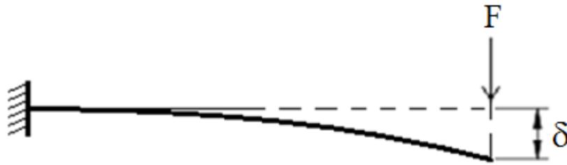
**Figura 5** – Eixo fletido devido ao desbalanceamento.
