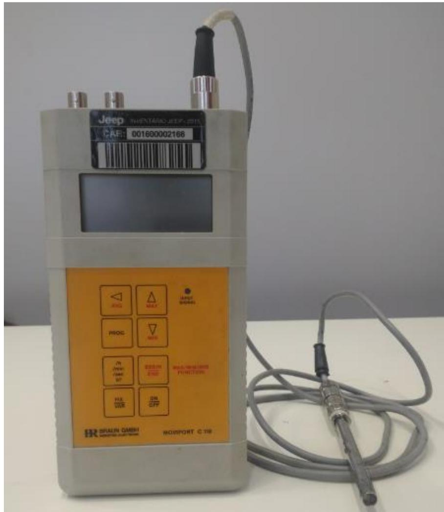
**Figura 17** – Tacômetro ótico.
