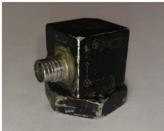
**Figura 16** – Acelerômetro T356A16.
