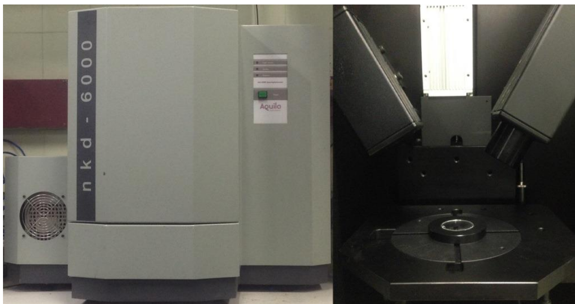
Figura 4.13: Aparato experimental para caracterização por elipsometria para filmes finos.(Laboratório de Polímeros Não-Convencionais DF-UFPE.)
