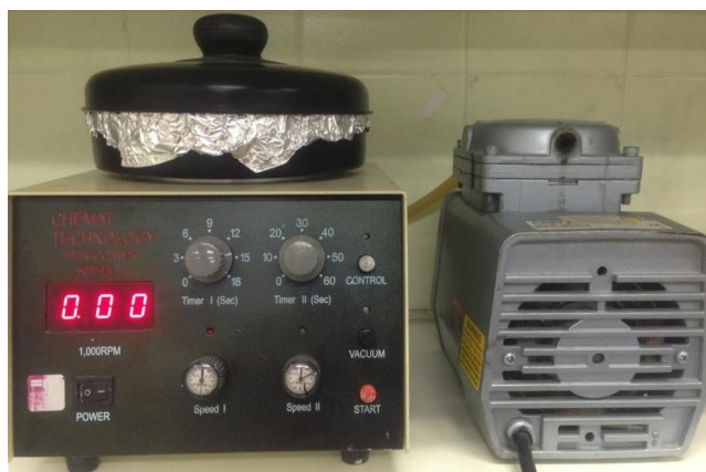
Figura 4.7: Equipamento de deposição de filmes por spin-coating de dois estágios (Chemat Technology, EUA). (Lab. de Polímeros Não-Convencionais, DF-UFPE.)
