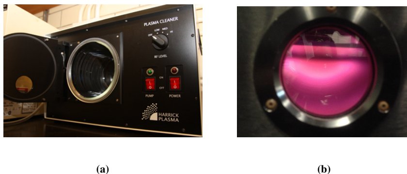
Figura 4.5: Detalhe do equipamento para tratamento a plasma (a) da HARRICK e em (b) substratos em ambiente de plasma. (Laboratório de Polímeros Não-Convencionais – DF-UFPE)
