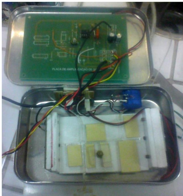
**Figura 8:** Foto da caixa metálica (a) com a cela de fluxo e parte eletrônica (b).
