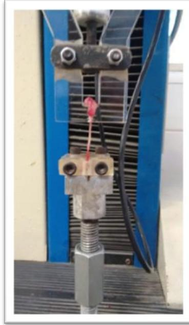
**Figura 4** – Máquina de Ensaio mecânico convencional (EMIC) do Laboratório de Materiais Poliméricos - Departamento de Engenharia Química da UFPE (modelo DL 500, Brasil).
