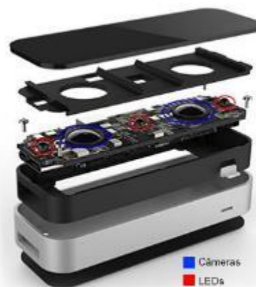
Figura 16 - Sistema de LED's e Câmeras
