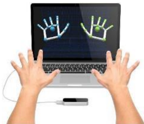
Figura 15 - Demonstração do uso do Leap motion
