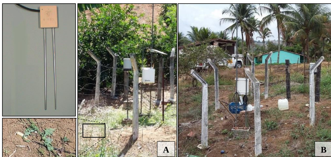
Figura 5 - Sensor de umidade do solo CS616 e localização da estação EP1 (A); localização da estação EP2 (B).
