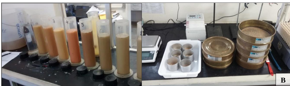
Figura 7 - Ensaio de granulometria do solo. Sedimentação (A) e peneiramento (B).
