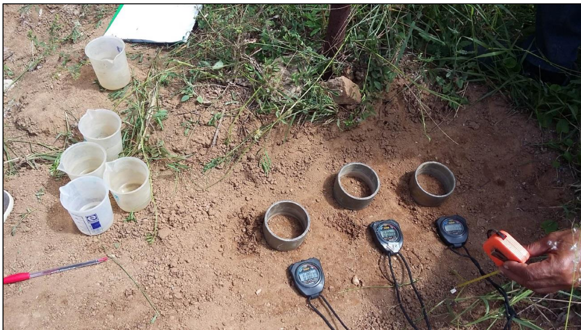
Figura 8 - Teste de infiltração tridimensional com infiltrômetro de anel simples.
