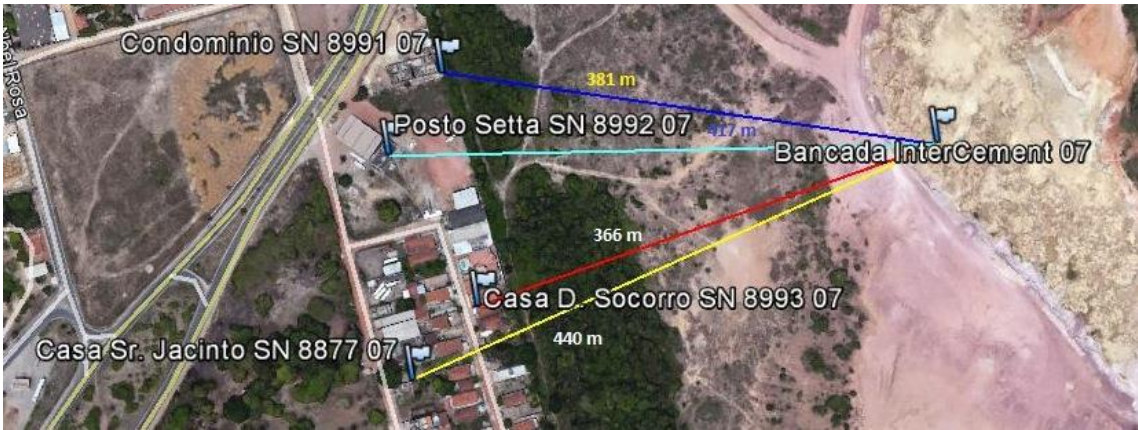
Figura 26 - Localização dos pontos monitorados, no dia 07/05/2015, a partir da Bancada de Detonação: Ponto 1 (Condomínio), Ponto 2 (Posto Setta), Ponto 3 (Res. Sra. Socorro) e Ponto 4 (Residência Sr. Jacinto).
