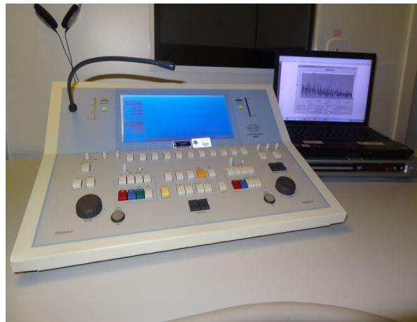
Figura 4.4 - Sistema MASTER acoplado ao audiômetro de dois canais
