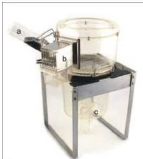
Figura 3 – Gaiola Metabólica própria para ratos (Tecniplast 3701M081), (a) mamadeira para água; (b) Câmara de alimentação; (c) Funil coletor de fezes e urina.
