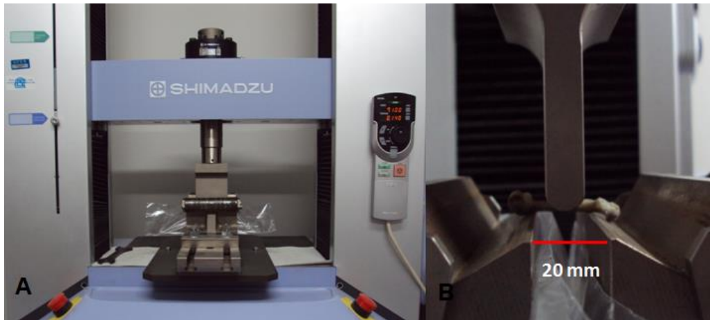
Figura 7 – (A) Máquina de ensaio mecânico convencional Shimadzu Autograph AG-X; (B) Fêmur posicionado na máquina de ensaio de flexão em três pontos.
