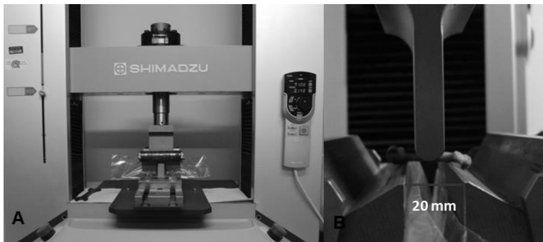
Figura 1 – (A) Máquina de ensaio mecânico convencional Shimadzu Autograph AG-X; (B) Fêmur posicionado na máquina de ensaio de flexão em três pontos.
