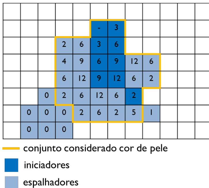
**Figura 4.6:** Ilustração da execução da propagação de potencial em um conjunto de *pixels*. Para um *pixel* ser considerado cor de pele é necessário que seja um iniciador, ou então que seja um espalhador com potencial maior do que 1.
