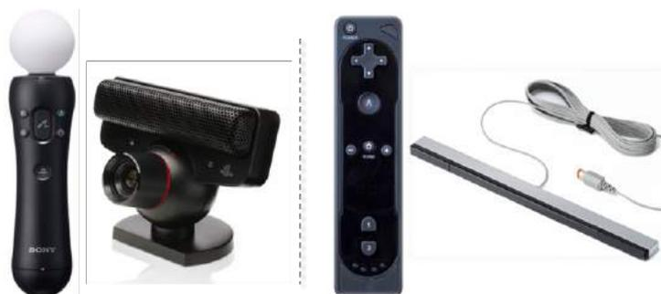
**Figura 3.5:** Esquerda: PS Move (joystick) e PS Eye (câmera), acessórios para o Playstation 3 (SONY 2010). Direita: Wii Remote, equipado com uma câmera infravermelha na extremidade superior, e Wii Sensor Bar, com 5 LEDs infravermelhos em cada extremidade lateral (NINTENDO 2006).
