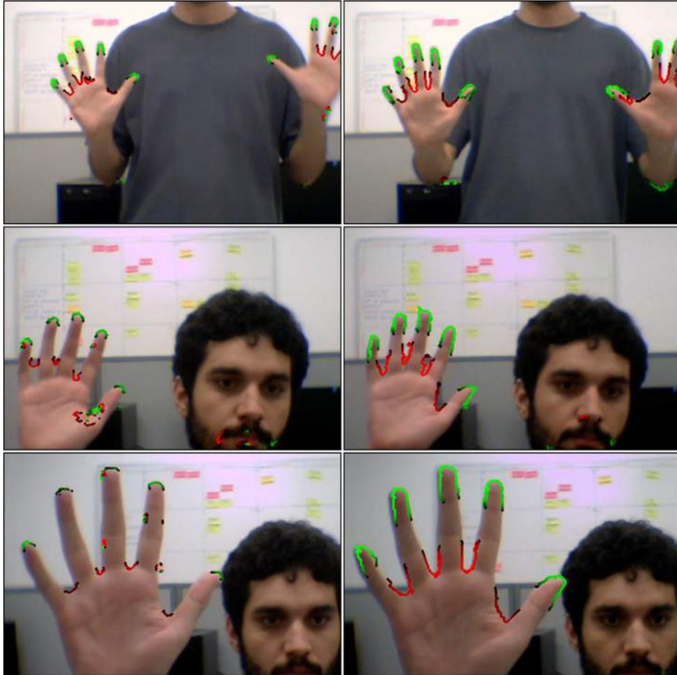
**Figura 4.12:** Cálculo de cossenos de cada um dos pontos do contorno. Na coluna da esquerda, resultados através do método de detecção em (PAN *et al.* 2010); na coluna da direita os resultados do método proposto. Pontos esverdeados representam cossenos internos (“abraçando” regiões de pele) enquanto que pontos avermelhados retratam cossenos externos. O limiar para o menor valor de cosseno é de 0, ou seja, somente ângulos iguais ou inferiores a 90 são considerados.
