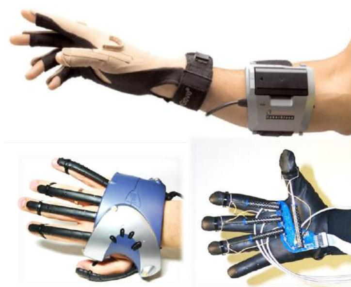
**Figura 3.3:** Luvas táteis (haptic gloves). Topo: CyberGlove II (CYBERGLOVE 2010); Esquerda: P5 Glove (CYBERWORLD 2012); Direita: Rutgers Master II-ND (POPESCU *et al.* 1999).
