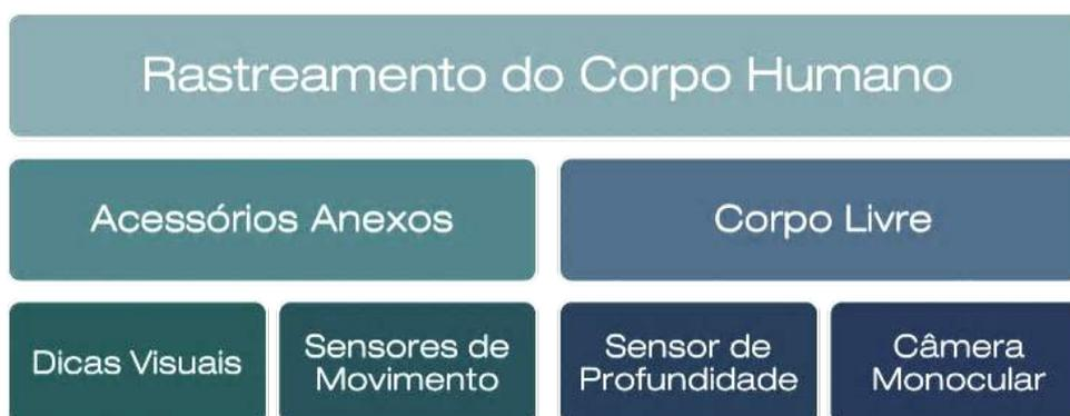
**Figura 3.2:** Classificação de técnicas de rastreamento do corpo humano a partir de critérios de uso.
