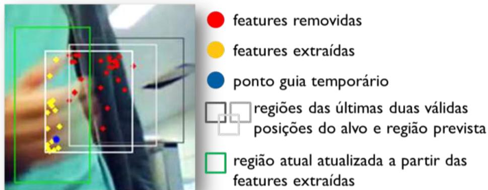
**Figura 4.17:** Exemplo de reinicialização automática. Através da predição de uma nova região de interesse, features são extraídas após uma falha para que o alvo continue sendo rastreado.
