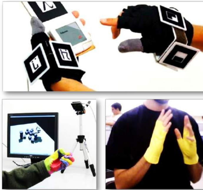
**Figura 3.4:** Topo: marcadores fiduciais (VEIGL *et al.*2002); Esquerda: luva multicolor (WANG *et al.* 2009); Direita: luvas amarelas (FIGUEIREDO *et al.* 2009) como exemplos de acessórios como pistas visuais para o rastreamento do corpo.
