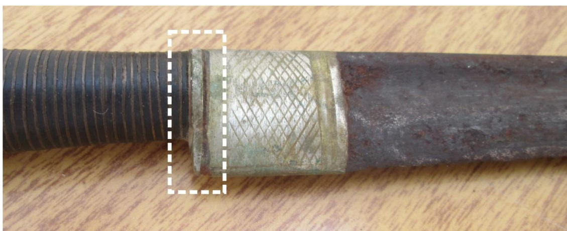
Figura 86 - Detalhe para uma “guarda” residual em faca “jardineira”
