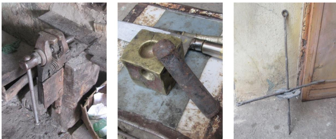
Figura 83 - “Morsa”, “embutideira” e furadeira manual. Instrumentos hoje pertencentes a Simião Pereira
