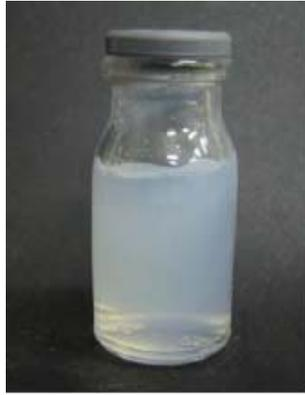
**Figura 5.** Biogel obtido através da membrana de Biopolímero produzido pela *zoogloea sp.* (NÉRIS, 2007; LIMA et al, 2004).
