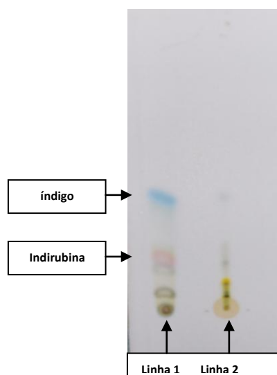
Figura 5. Derivados indigóides obtidos a partir de extrato metanólico de folhas de I. suffruticosa armazenadas em diferentes temperaturas. Linha 1 folhas em 5°C e linha 2 folhas à temperatura ambiente.
