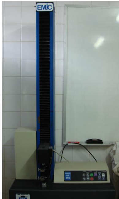
Figura 16. Máquina universal de testes EMIC® DL500 utilizada para realização dos testes biomecânicos
