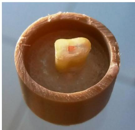
Figura 1- Modelo com espécime incluído em resina acrílica.
