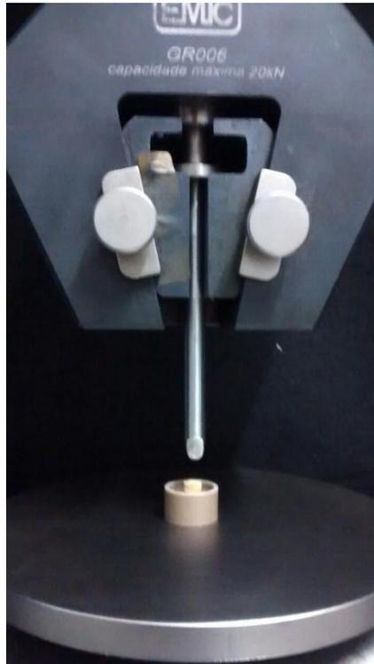
Figura 2- Teste de Compressão, evidenciando o posicionamento do espécime sobre o platô, logo abaixo do cinzel.
