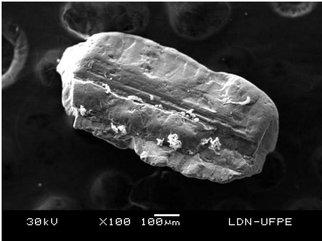
Figura 77: Imagem de MEV ampliada de grão de Ilmenorutilo, apresentando fratura conchoidal (seta amarela), marca de choque por partícula aderente (seta vermelha) e presença de sulcos (seta azul).
