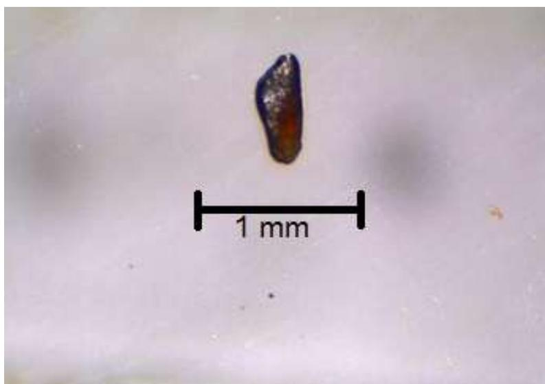
Figura 76: Imagem de MEV de grão de ilmenorutilo (variação do rutilo que contém ferro em sua composição química). Em sua superfície apresenta sulcos.
